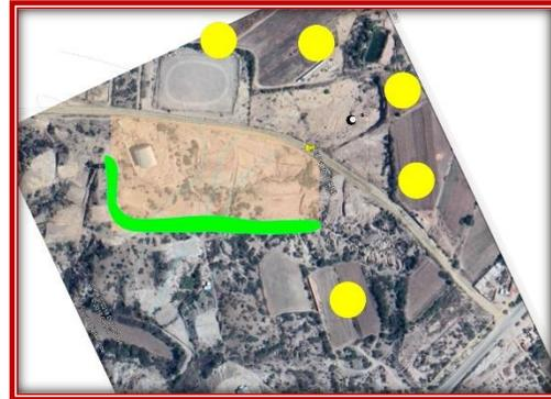
Esta premisa es importante ya que al tener curvas de nivel el bloque debe estar en dirección al viento, el bloque principal tendría que estar paralelamente a las curvas de nivel más alto. Para no romper con el viento y no afectar la topografía.
