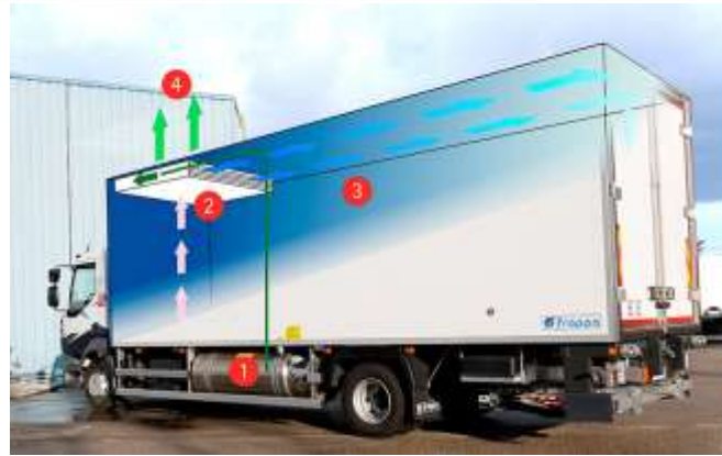
Ilustración 7: funcionamiento del camión frigorífico criogénico con nitrógeno https://www.messer-cl.com/documents/funcionamiento+sistema+ecolin/be
