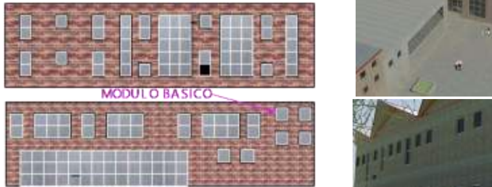
Figura 121. Armonía de vanos en fachadas del proyecto
