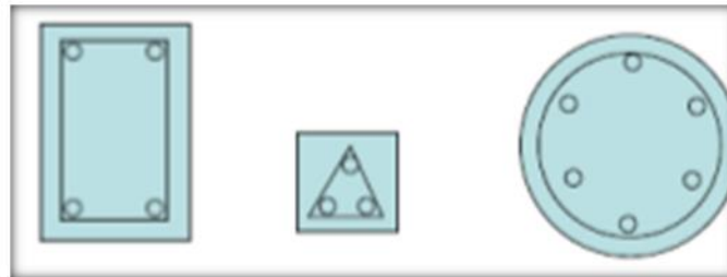
Figura 2.13. Armadura en columna
