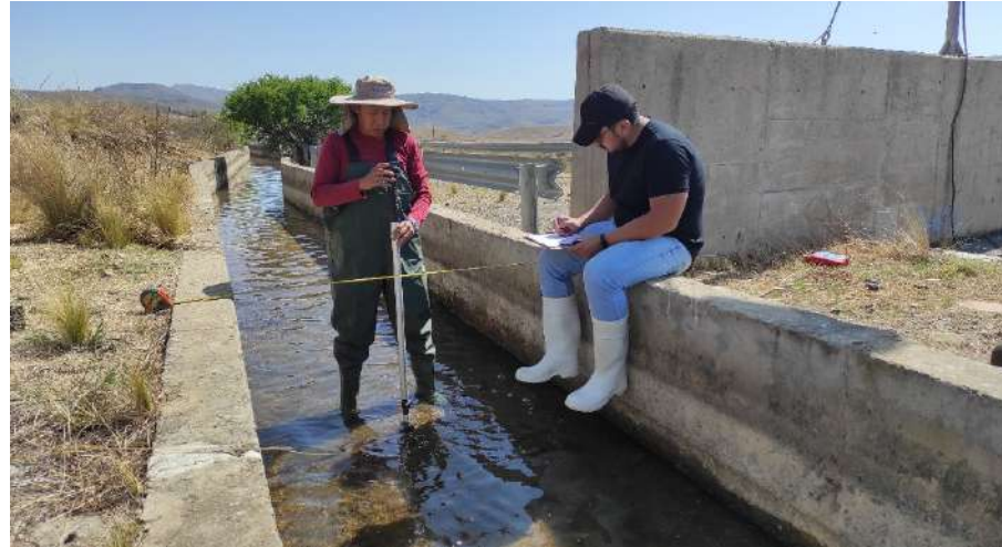
Medición con molinete
