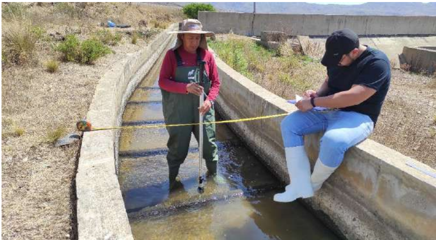
Medición con molinete
