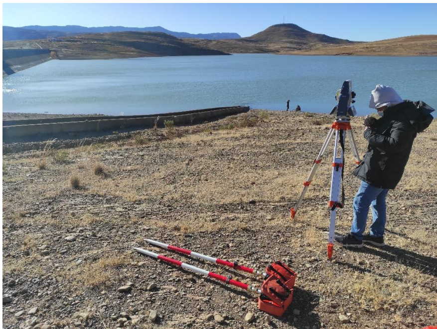
Posicionamiento de la estación total.
