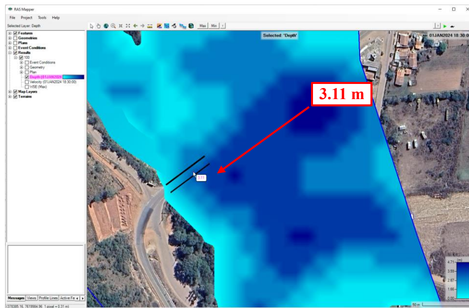
Gráfico 18. Tirante en el pilar del puente
