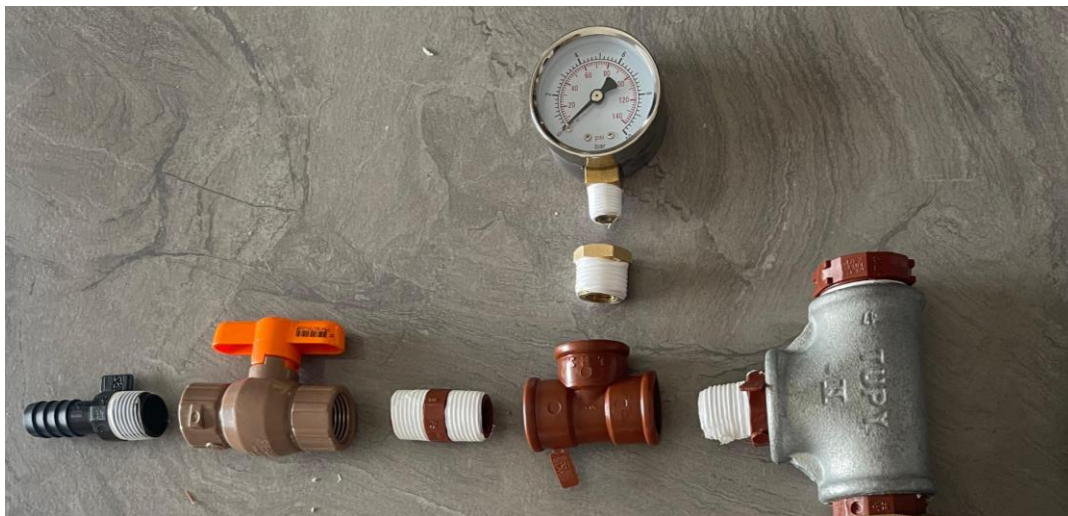
Figura N° 5. Línea secundaria. Manómetro y conducto de descarga. Fuente: Elaboración propia.
