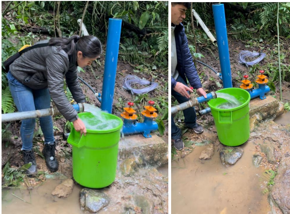
Figura N° 2. Medición del caudal de suministro. Fuente: Propia.
