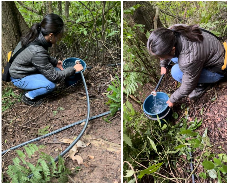
Figura N° 4. Mediciones a 140 m de distancia a la bomba de 4". Fuente: Elaboración propia.
