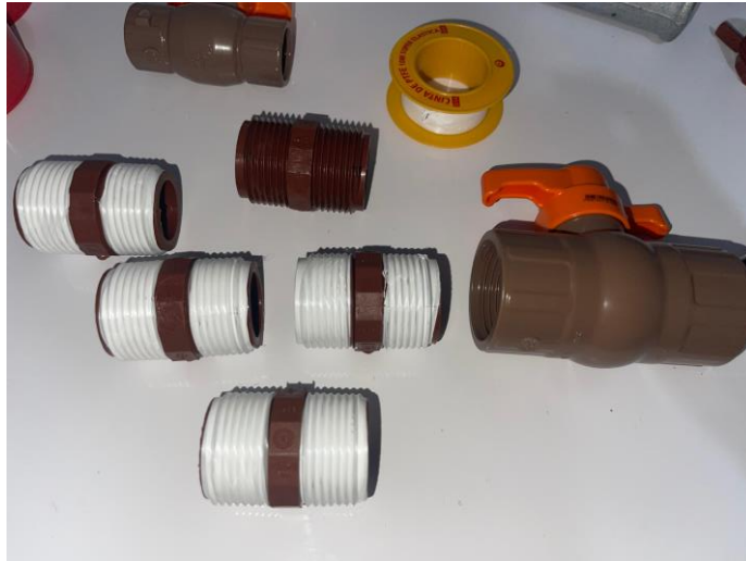
Figura N° 4. Preparación de piezas con conexiones roscadas. Fuente: Propia.
