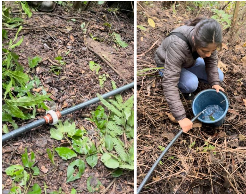
Figura N° 5. Mediciones a 240 m de distancia a la bomba de 4".
