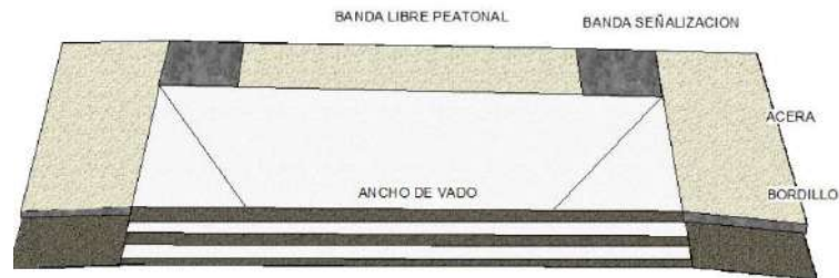
rampa con señalización lateral
