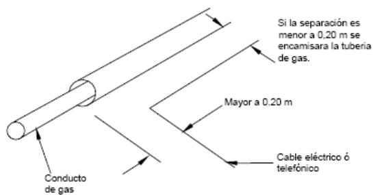
El material del encamisado ó funda aislante podrá ser de: PVC, amianto-cemento, hormigón, etc.
