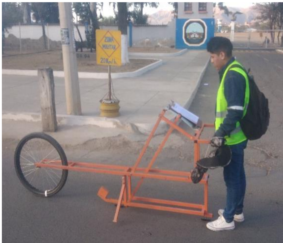
Figura 23: Equipo para la medición de la rugosidad superficial con Merlín
