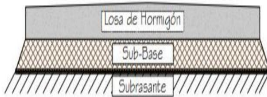
Figura 4: Estructura de un pavimento rígido
