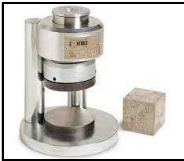
Figura 14. Dispositivo para ensayos a compresión de cementos y morteros.
