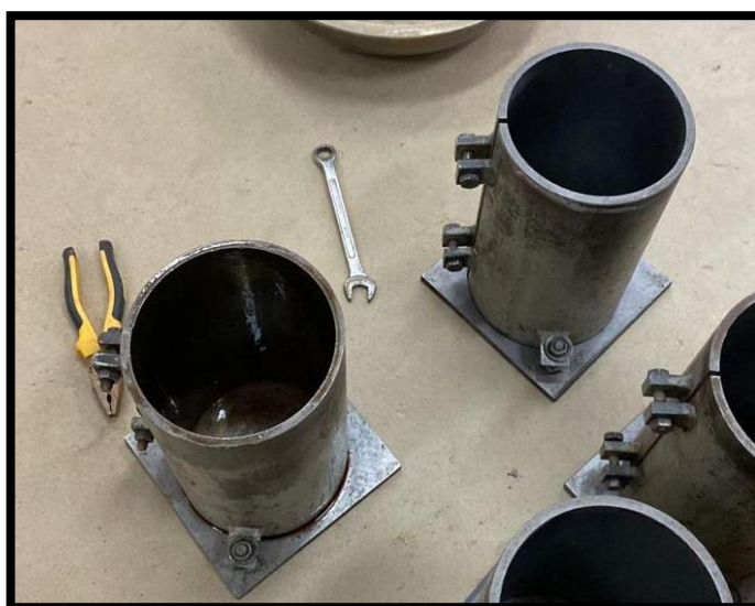
Figura 28. Engrasado al molde de probetas.
