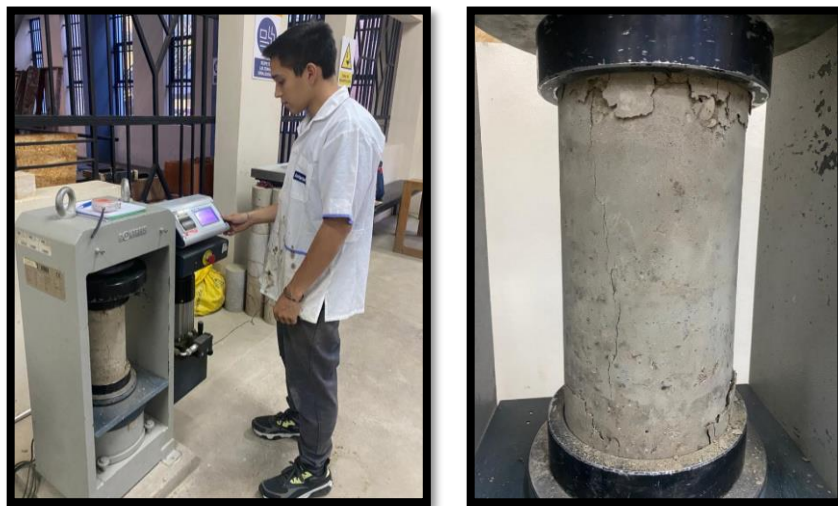
Figura 33. Rotura de probetas en prensa hidráulica.
