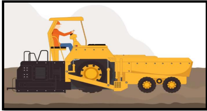
Figura 21. Mezcla del suelo con el cemento del pavimento unicapa.
