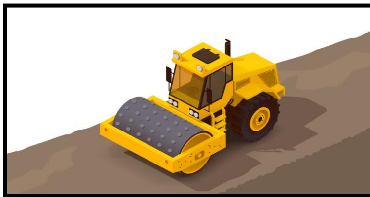
Figura 23. Compactación con rodillo pata de cabra del pavimento unicapa.
