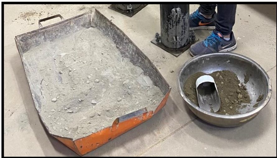
Figura 29. Preparación de muestra suelo – cemento.
