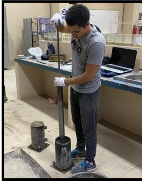
Figura 30. Compactación de las probetas.
