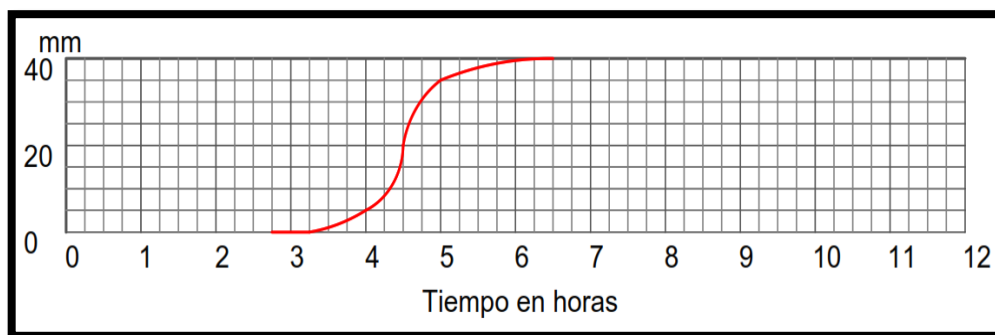
Figura 12. Curva de fraguado de un cemento Portland medio.
