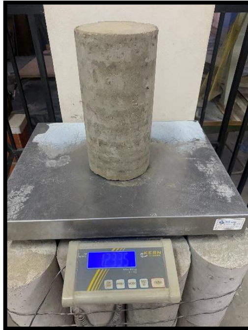
Figura 32. Pesaje de especímenes de pavimento unicapa.
