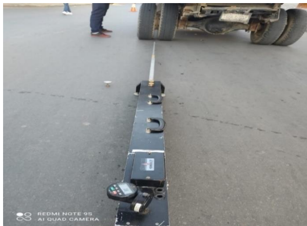
Figura 25: Viga Benkelman alineada
