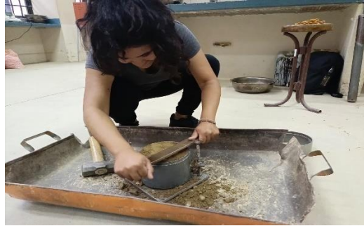
Figura 37: Alisando superficie con un enrasador
