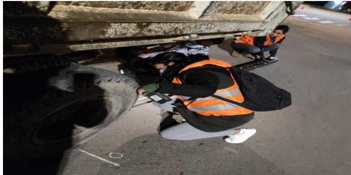
Figura 24: Instalación de la viga Benkelman
