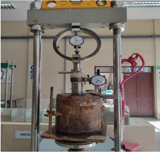
Figura 41: Resistencia a la penetración
