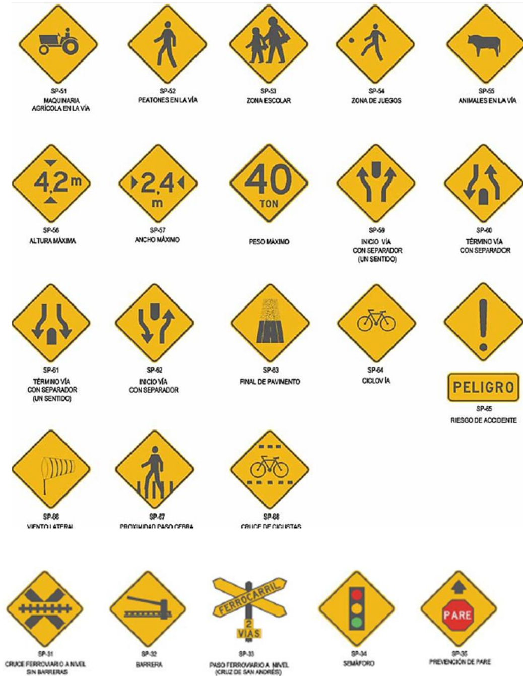
Figura. 2.13. Señales preventivas de una vía
