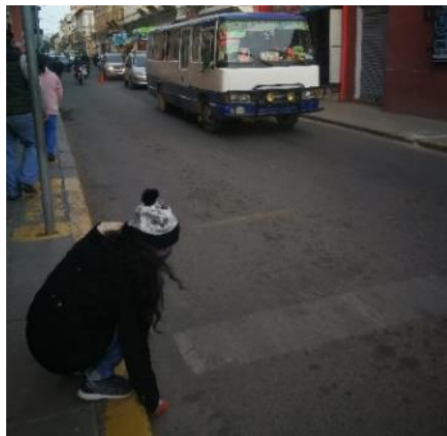
Figura 3.37. Medición del tramo de 50 mt para determinar la velocidad de punto
