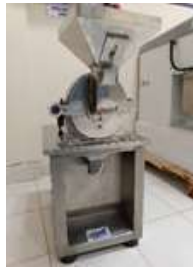
Figura 4.29: Equipo en la etapa de molienda con molino industrial
