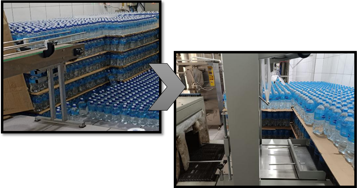
Figura 3-19 Armado y horneado de agua purificada
