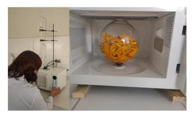
La extracción del aceite esencial, comienza con la ebullición del agua dentro del balón, a 93 °C y a 0,94 atm (temperatura de ebullición del agua a la presión atmosférica de Tarija), como se muestra en la tabla II-3.
