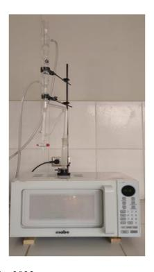
Para la extracción del aceite esencial, se procedió al cargando del balón de 2 litros con 200 gramos de cáscara y se añadió un volumen de agua de 800ml y 1400 ml, según lo planteado en el diseño experimental de este estudio.
