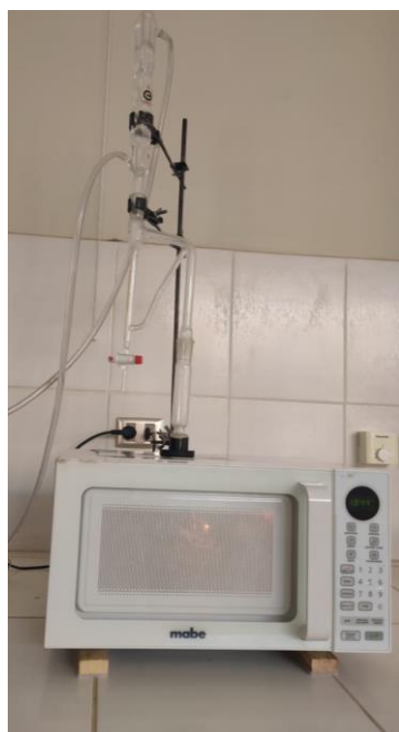
Foto 5. Proceso de hidrodestilación asistida por microondas
