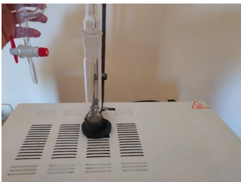
Foto 3. Adaptación del horno de microondas
