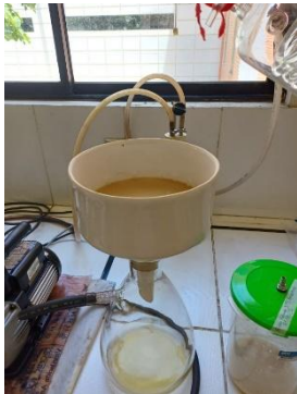
Filtración al vacío
