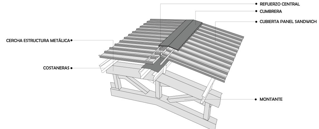
**DETALLE CONSTRUCTIVO CUBIERTA EN CERCHAS - ESC. 1:10**
