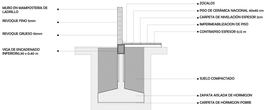
**DETALLE CONSTRUCTIVO PISO CERAMICO - ESC. 1:20**
