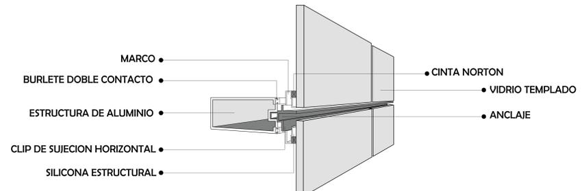
**DETALLE CONSTRUCTIVO SISTEMA STICK - ESC. 1:2**
