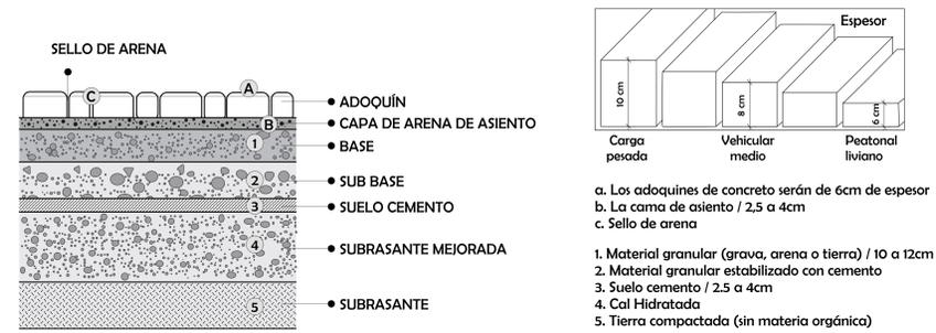
**DETALLE CONSTRUCTIVO PISO DE ADOQUIN - ESC. 1:10**
