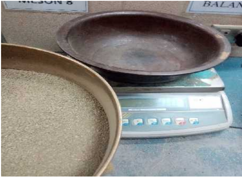
Ensayo de granulometría canal de trasvase progresiva 5+860 a 6+738.
