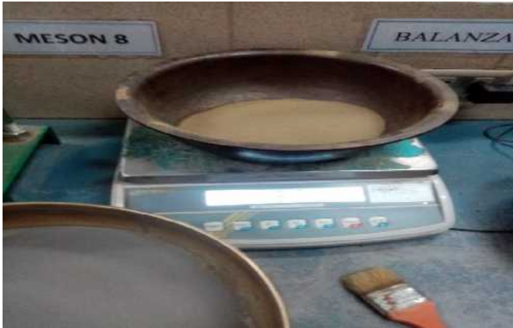
Ensayo de granulometría canal de trasvase progresiva 3+180 a 3+779,95.
