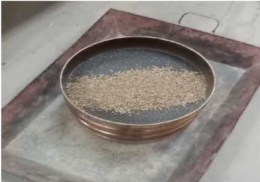
Ensayo de granulometría canal de trasvase progresiva 7+148 a 7+262,45.
