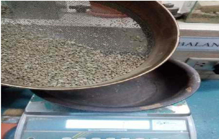
Ensayo de granulometría canal de riego Tárraga prog. 0+000 a 0+250.
