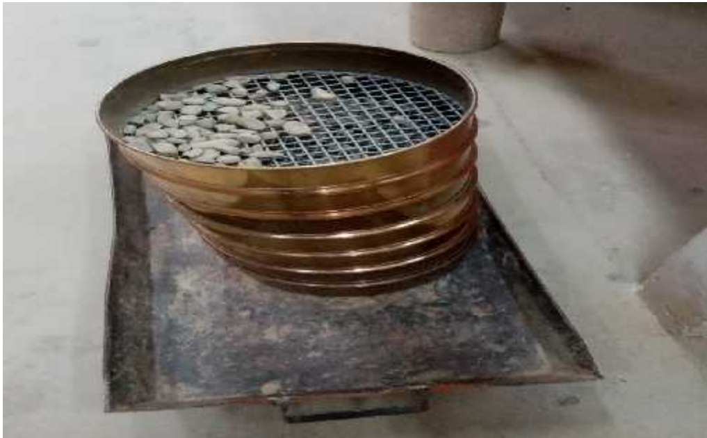
Ensayo de granulometría Canal de trasvase progresiva 0+090,50 a 1+000.
