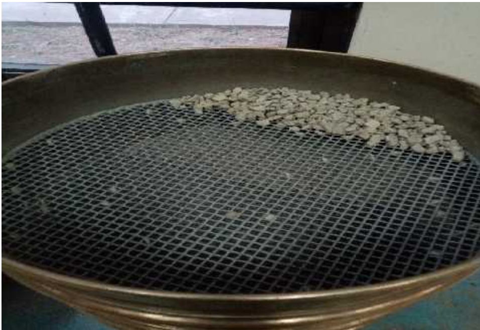
Ensayo de granulometría canal de trasvase progresiva 5+215,60 a 5+860.
