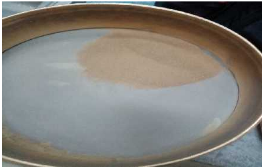
Ensayo de granulometría canal de trasvase progresiva 0+000 a 0+076.
