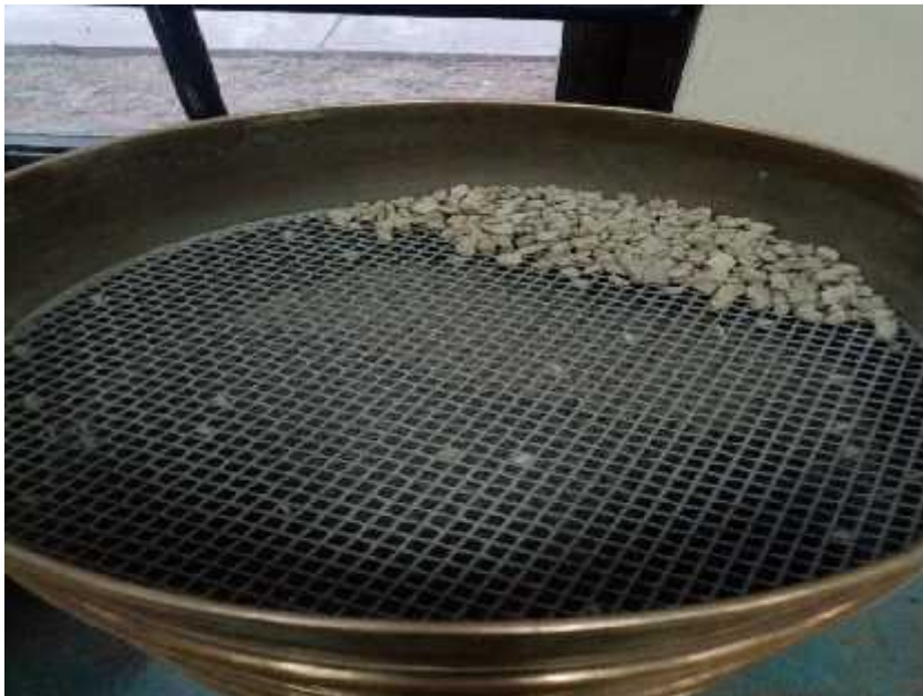
Ensayo de granulometría canal de riego Tárraga prog. 0+250 a 0+400
