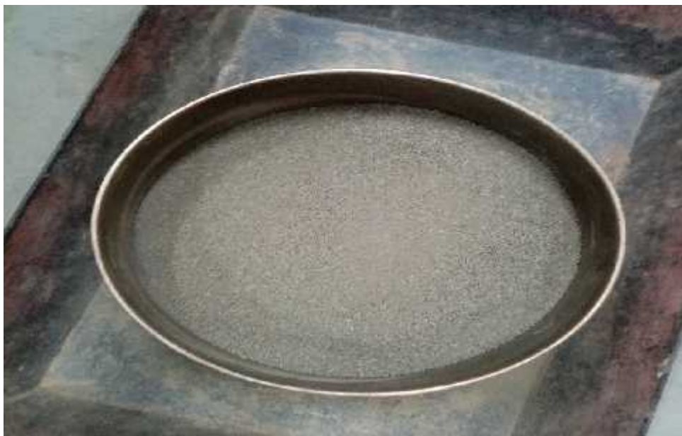
Ensayo de granulometría canal de trasvase progresiva 8+408,050 a 8+534,70.
