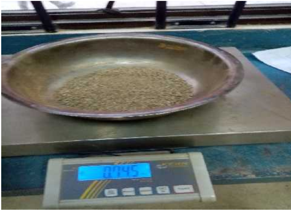
Ensayo de granulometría canal de riego Tárraga prog 0+400 a 0+501,11.
