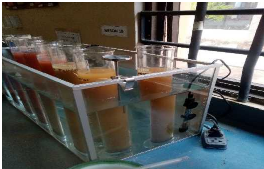
Ensayo del hidrómetro desarenador progresiva 0+076.
