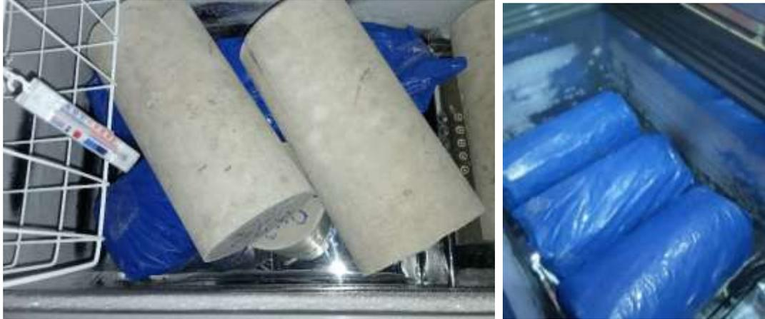
**Figura 3.15: Probetas de hormigón sometidas a congelamiento**
