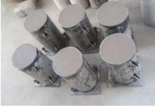
**Figura 3.11: Enrase de probetas**
