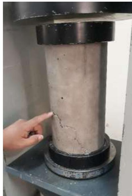
*Figura 3.20: Ensayo de Rotura a Compresión*
