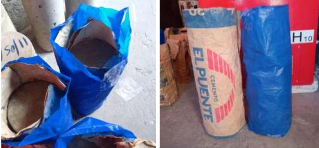
*Figura 3.14: Protección de las Probetas con Papel y Polietileno*
