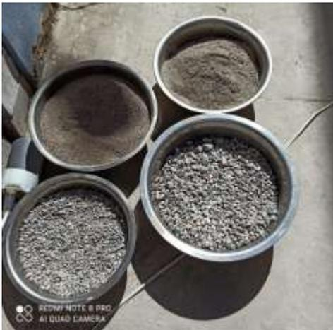
***Figura 3.8: Agregados para elaboración del hormigón***
