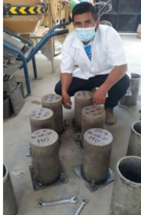
**Figura 3.12: Desmoldado e Identificación de Probetas**
