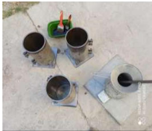
***Figura 3.9: Probetas con aceite***
