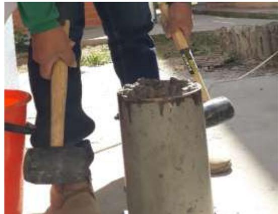
***Figura 3.10: Elaboración de probetas***
