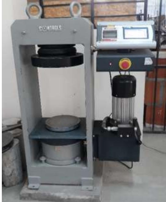
*Figura 3.5: Máquina de Compresión*
