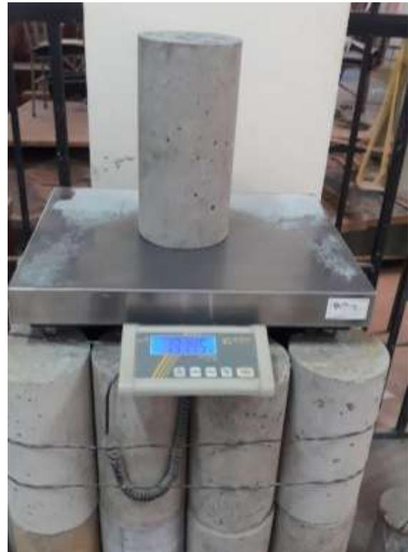
**Figura 3.19: Pesando la probeta**
