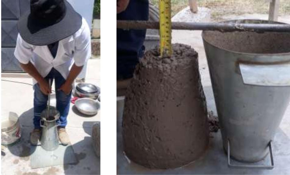
*Figura 3.7: Determinación del Asentamiento del Hormigón*
