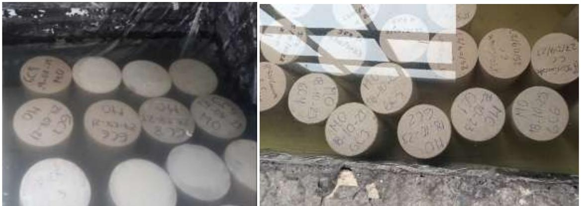
**Figura 3.12: Curado Sumergido de las Probetas.**
