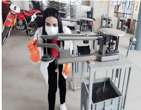
Figura N°3.4. Canastillo porta muestra
