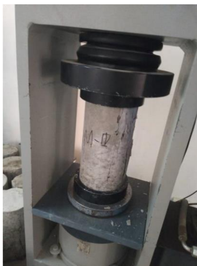
Figura N°2.3. Resistencia a la compresión
