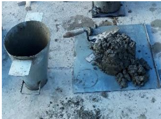
Figura N°3.9. Cono de Abrams
