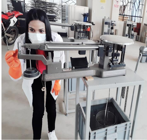
Figura N°A-9 Ensayo para determinar la densidad real de los áridos gruesos
