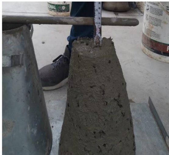
Figura N° A-14 Cono de Abrams
