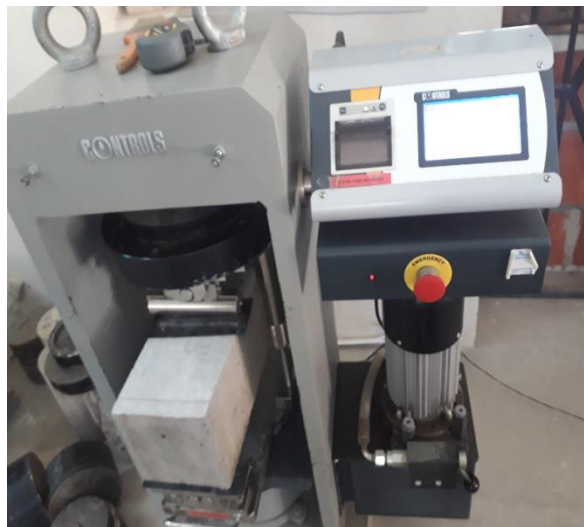
Figura N°A-19 Rotura a flexión
