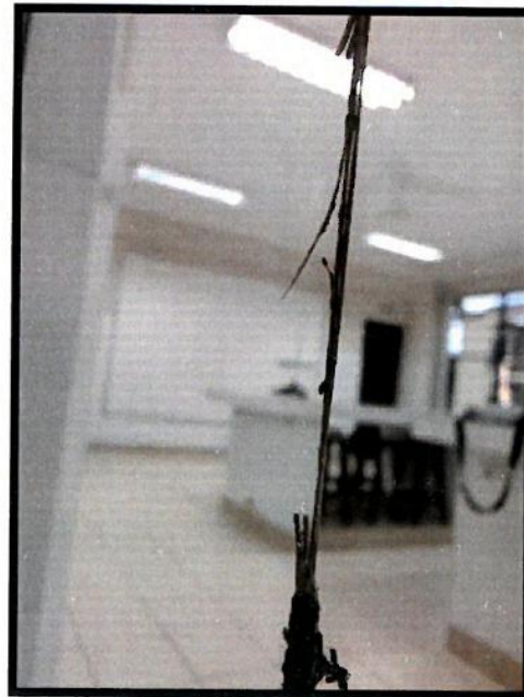
Comportamiento de la fibra a momentos de su ruptura
