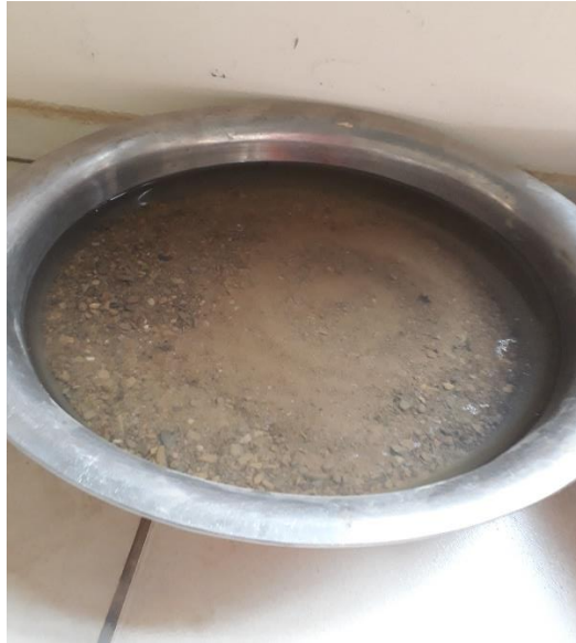
Figura N°A-3 Lavado del agregado fino
