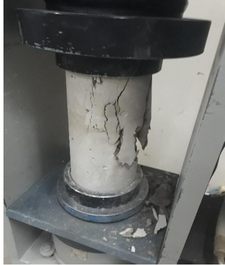
Figura N°A-17 Rotura a compresión
