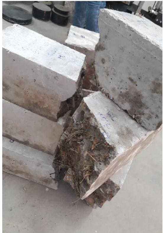
Rotura de probeta prismática
