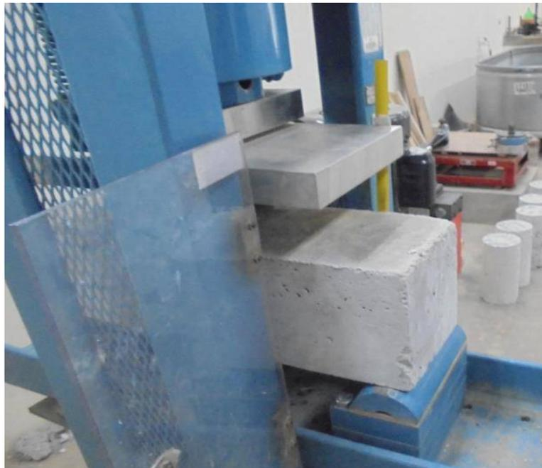
Rotura de vigas con 0,5% de adición de fibras de coco
