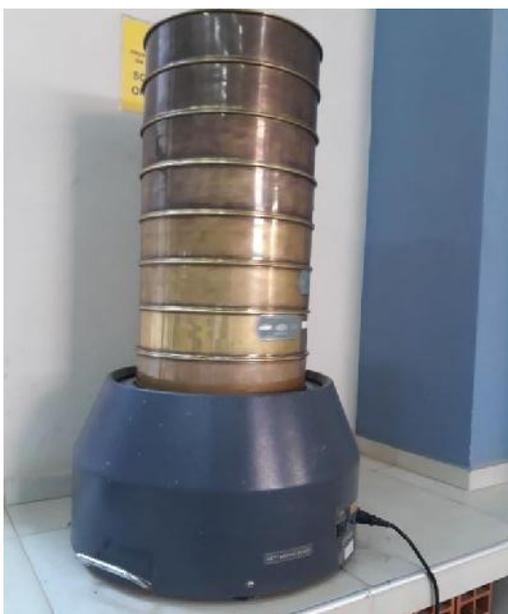
Peso del agregado retenido en las mallas
