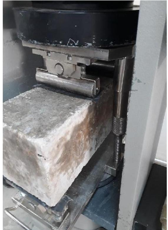
Rotura de probeta prismática
