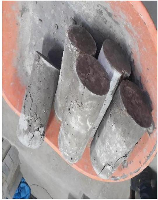
Rotura de probeta en prensa
