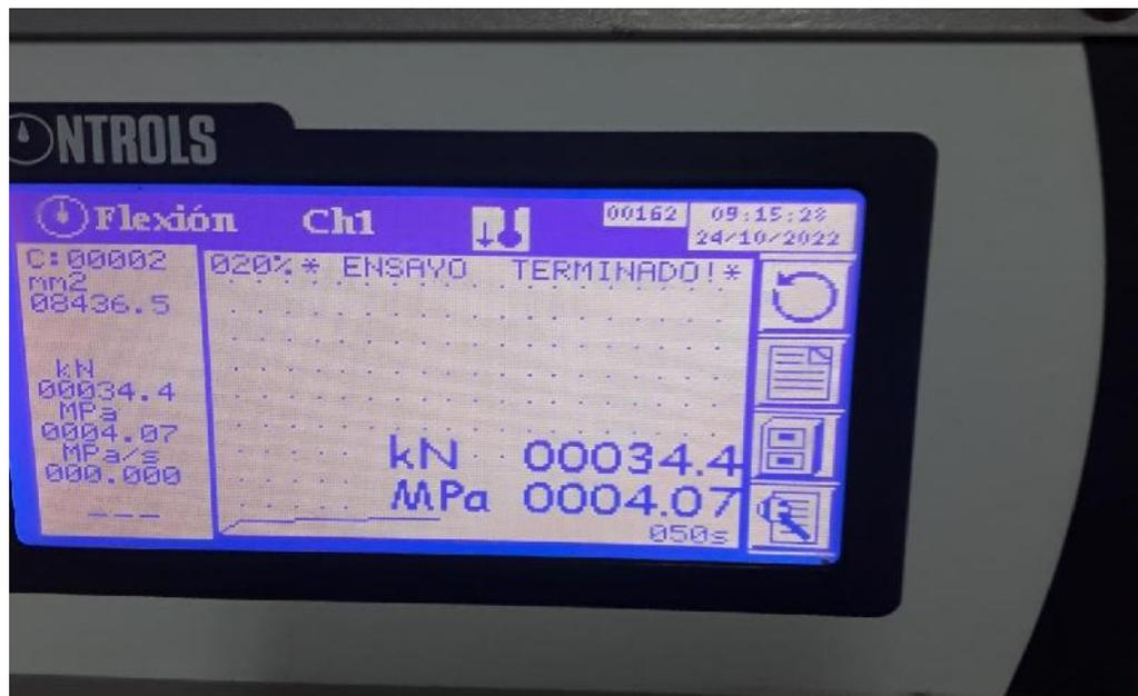
Rotura de vigas con 0,75% de adición de fibras de coco
