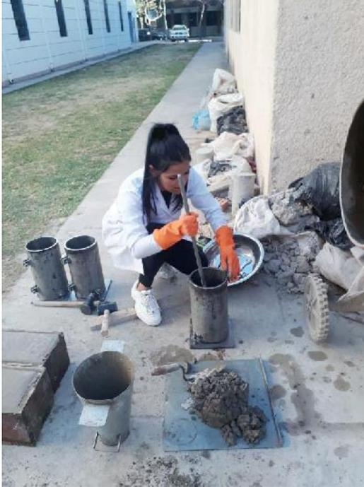
Prueba del cono de Abrams y medición del asentamiento
