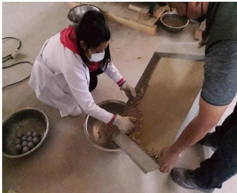
Elaboración de probetas cilíndricas
