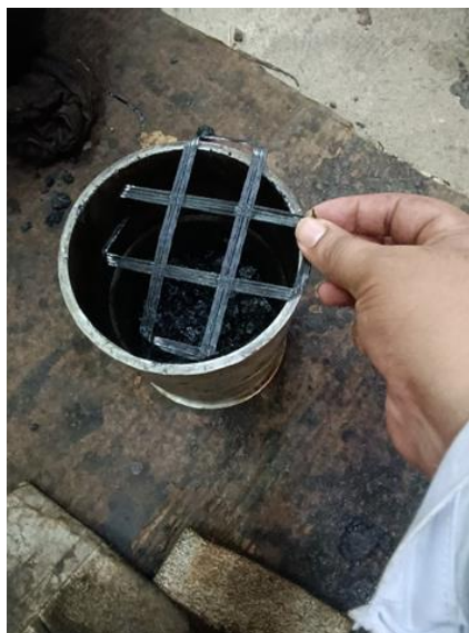
Figura 3.33 Incorporación de la geomalla a 2cm.
