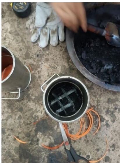
Figura 3.34 Incorporación de geomalla a 4cm.
