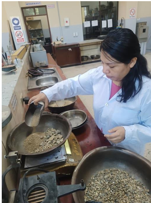
Figura 3.18 Pesando la cantidad de los agregados para la mezcla asfáltica
