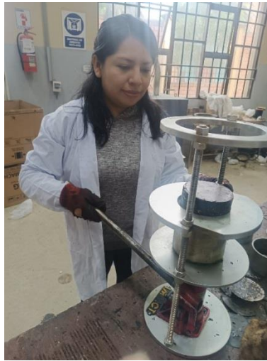
Figura 3.25 Extracción de la muestra con la ayuda de un gato hidráulico
