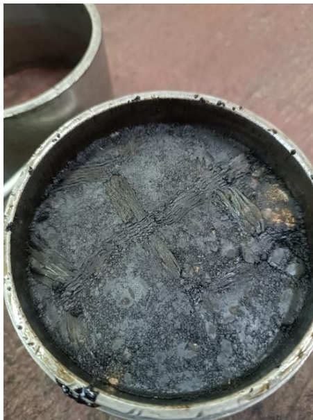
Figura 3.32 Briqueta con la geomalla a 0cm.
