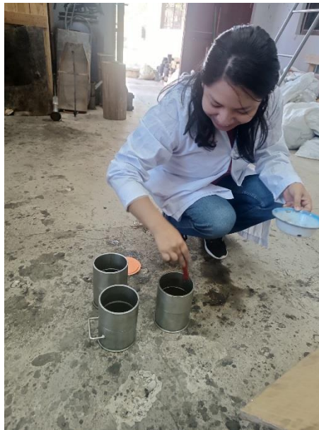
Figura 3.22 Aceitado de los moldes para facilitar el desmoldado
