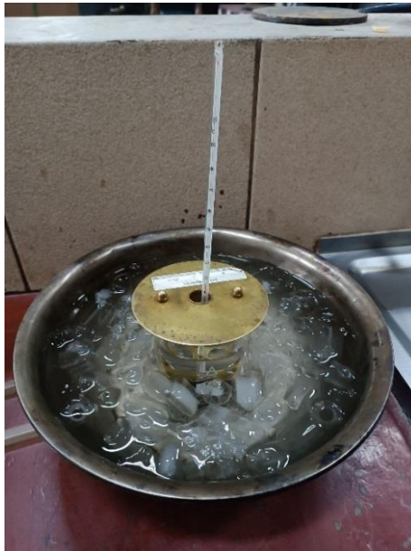
Figura 3.15 Realización del ensayo punto de ablandamiento
