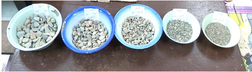
Figura 3.5 Colocando las muestras en los recipientes para posteriormente colocar el sulfato de sodio
