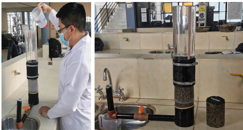
Figura 3. 9. Ensayo de permeabilidad
