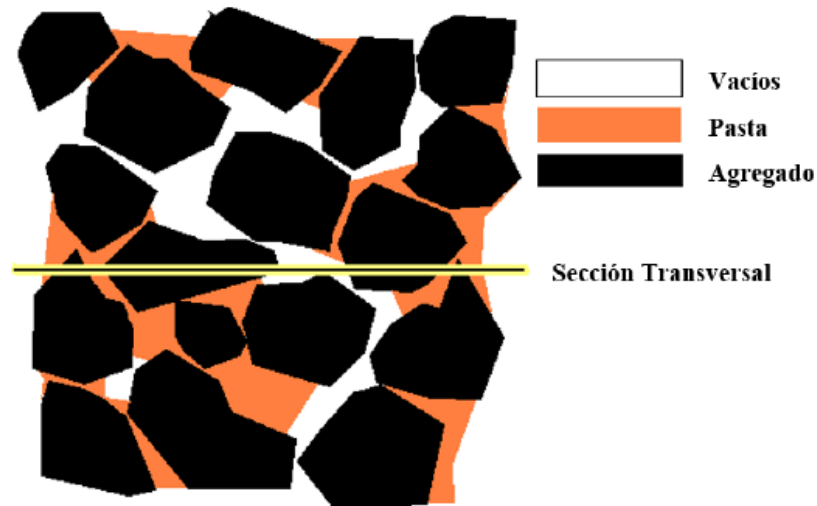
Figura 2. 6. Estructura interna del concreto permeable
