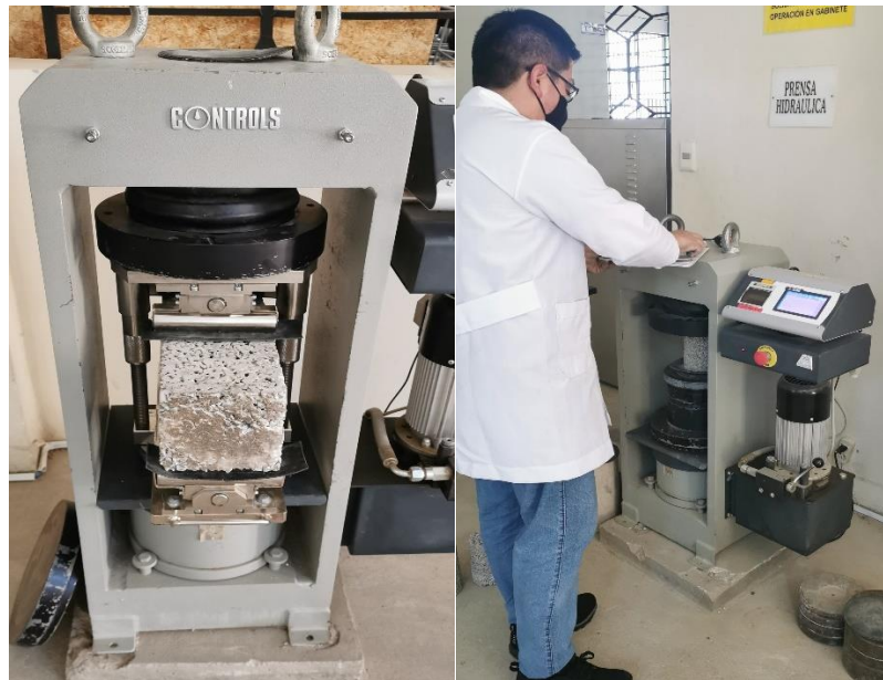
Figura 3. 8. Rotura de las probetas cilíndricas y las vigas
