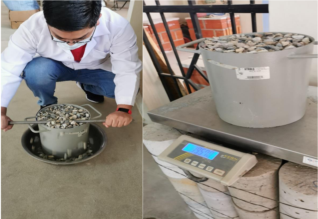
Realización del peso unitario del agregado grueso:
