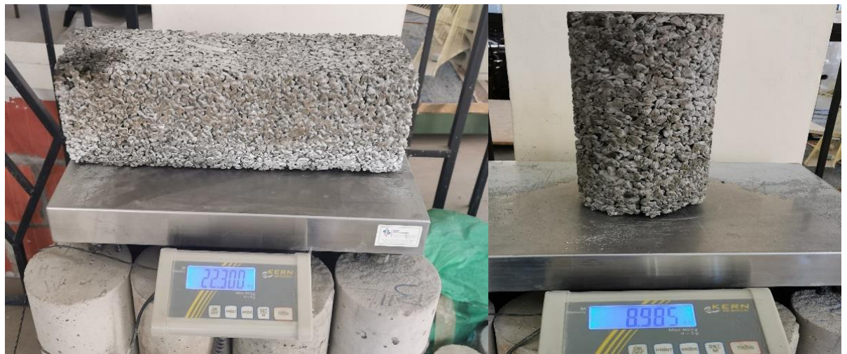
Pesaje de las vigas y cilindros
