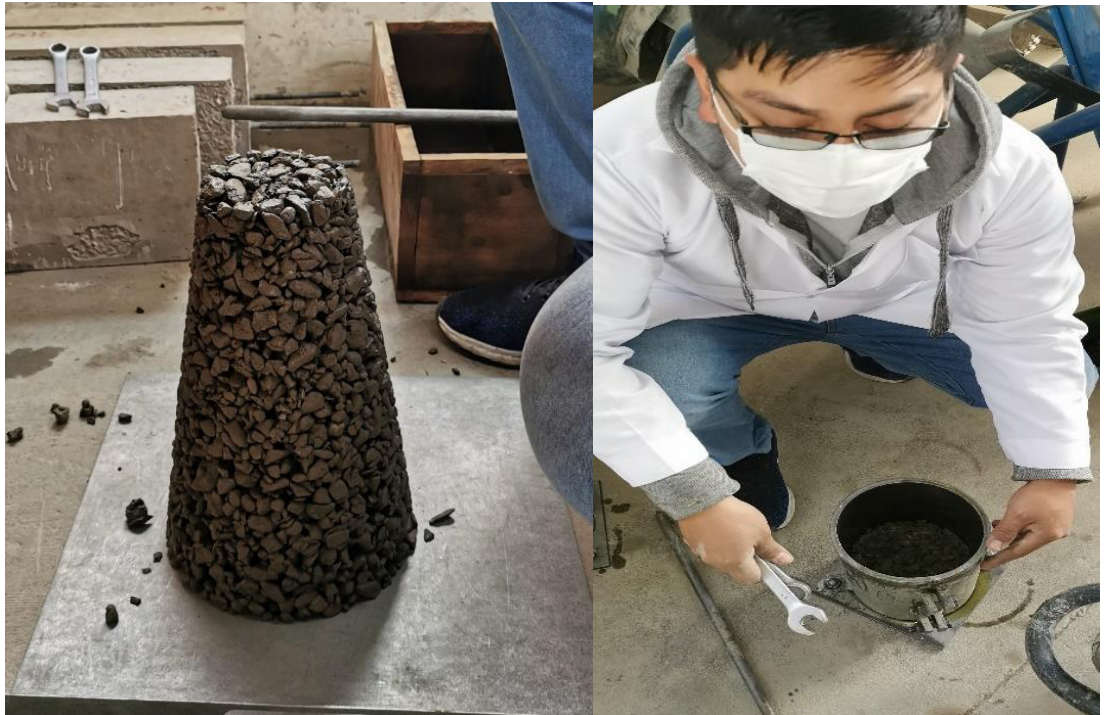
Ensayo cono de Abrams y vaciado en los moldes cilíndricos y vigas
