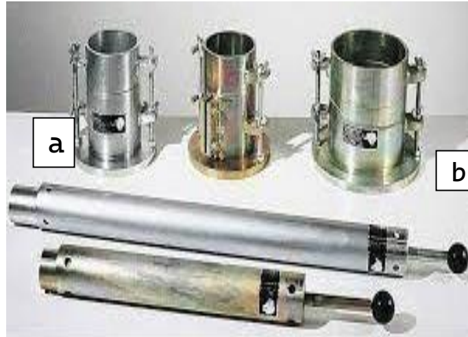
Figura 2.17 Equipo de compactación próctor estándar y modificado.
