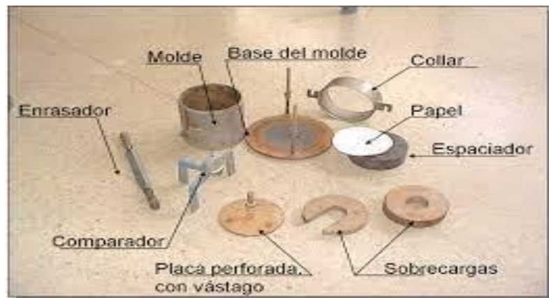
Figura 2.19 Molde y accesorios para ensayo CBR en laboratorio.
