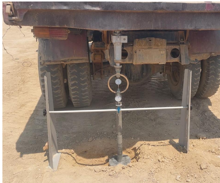
Figura 2.21 Ensayo de CBR In Situ.
