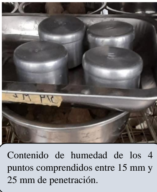
Figura 3. 36 Contenido de humedad de las penetraciones
