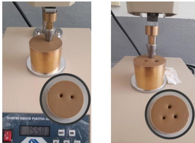
Figura 3. 25 Muestra con dos penetraciones y tres penetraciones
