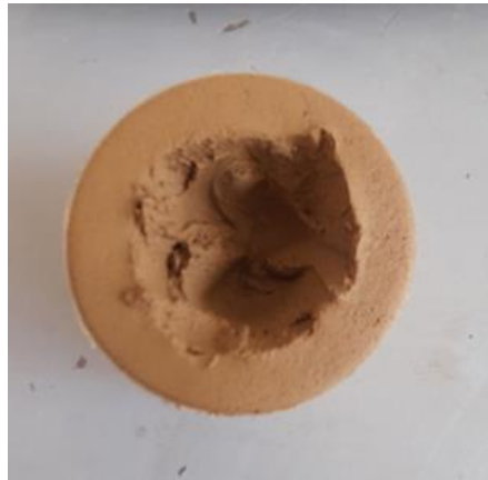
Figura 3. 26 Área penetrada por el penetrómetro de caída
