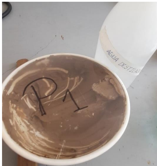
Figura 3. 11 Suelo preparado para reposar
