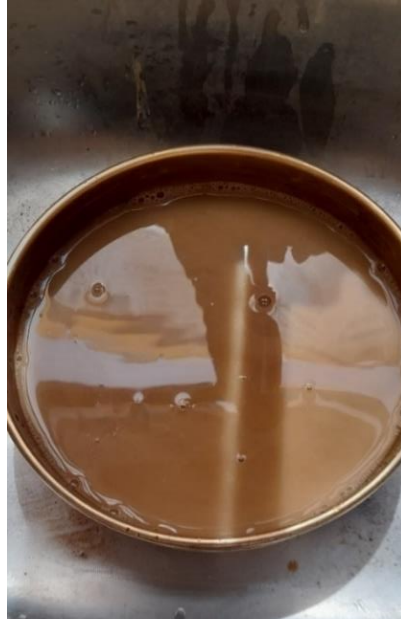
Figura 3. 6 Lavado de la muestra en el tamiz N° 200
