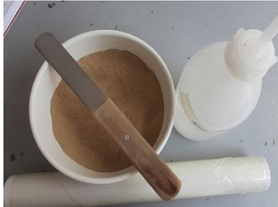
Figura 3. 10 Suelo triturado que pasa el tamiz N° 40
