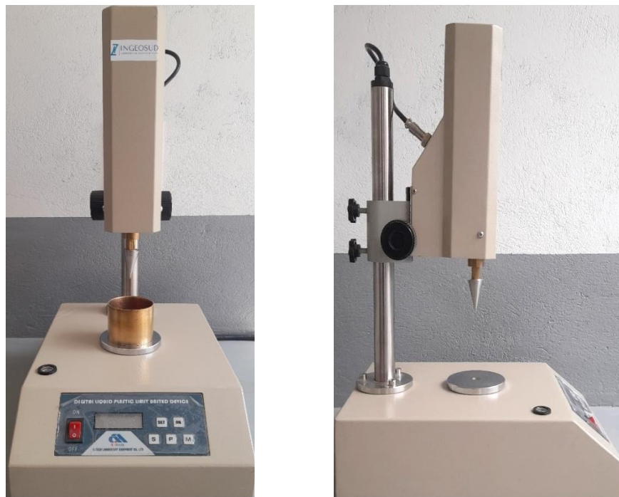
Figura 3. 21 Equipo con cono de 80 g para el LL
