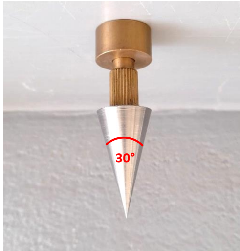
Figura 2. 27 Cono del penetrómetro de caída para el LL
