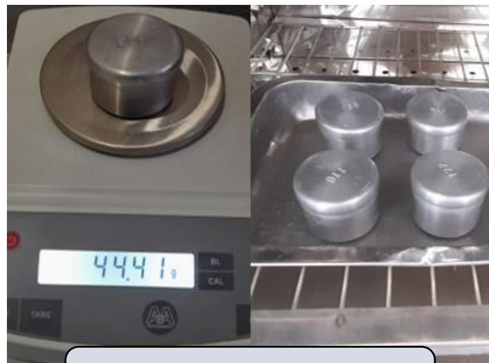
Figura 3. 15 Muestra con diferentes contenidos de humedad secada en horno
