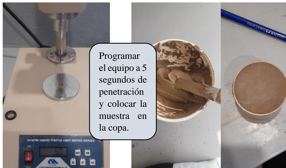
Figura 3. 33 Equipo programado a 5 segundos de penetración
