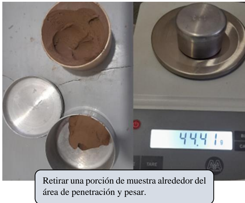
Figura 3. 35 Muestra retirada alrededor de las penetraciones
