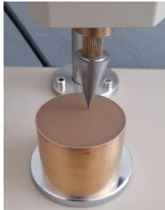
Figura 3. 24 Cono en contacto con la superficie del suelo
