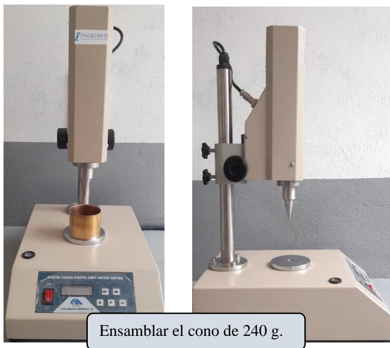
Figura 3. 31 Equipo con cono de 240 g para el LP
