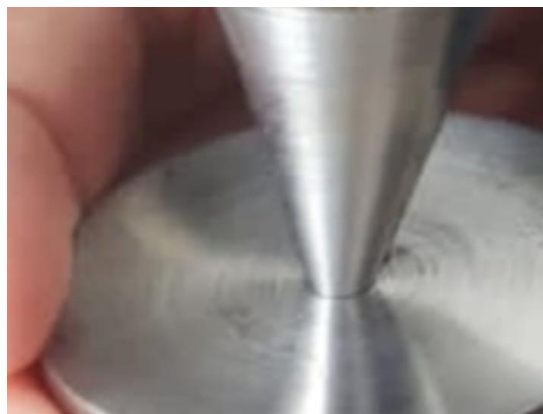
Figura 3. 32 Verificación de la punta del cono para el LP
