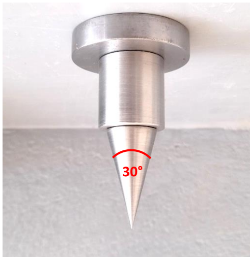
Figura 2. 28 Cono del penetrómetro de caída para el LP
