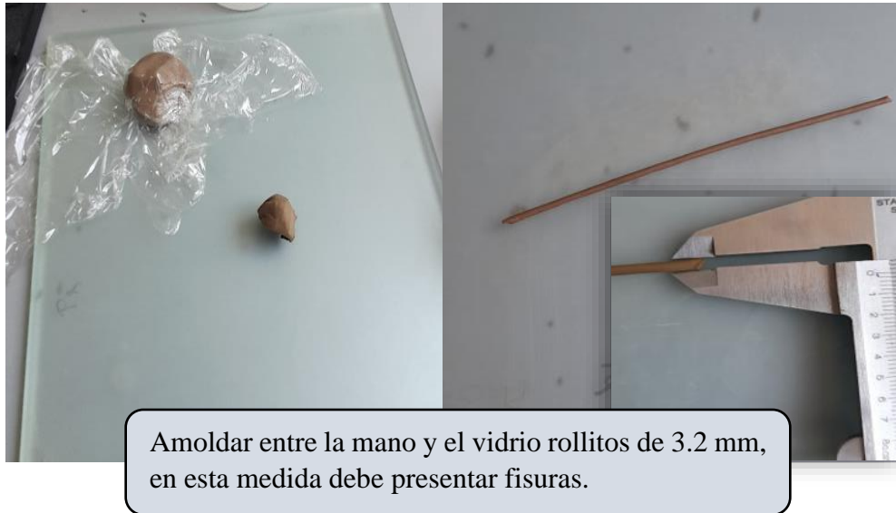
Figura 3. 16 Rollitos de 3.2 mm
