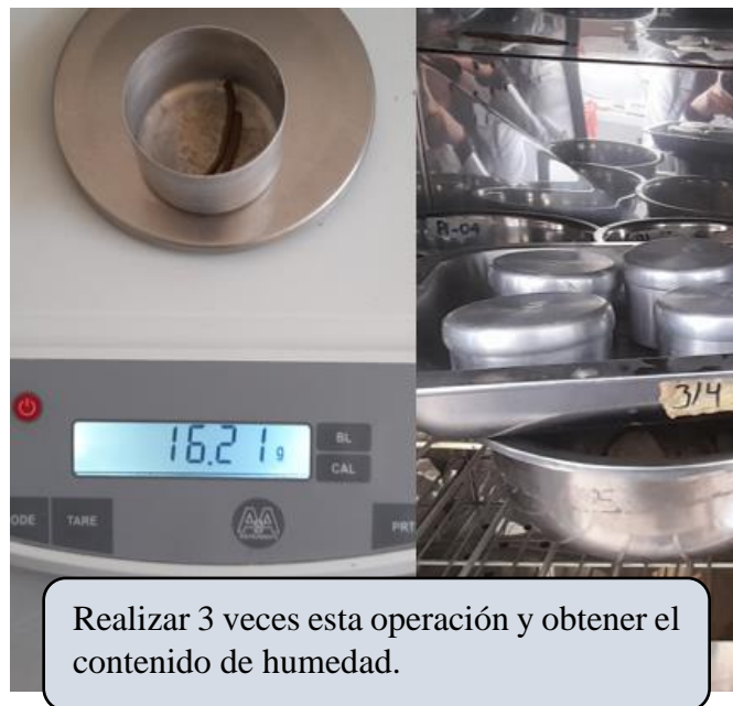
Figura 3. 17 Contenido de humedad de los rollitos
