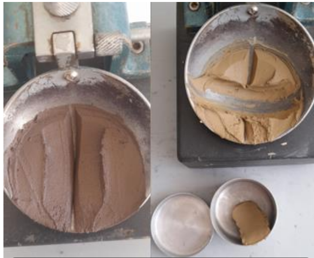
Figura 3. 14 N° de golpes y contenido de humedad
