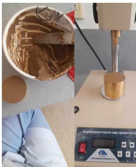
Figura 3. 23 Muestra en la copa para ensayar
