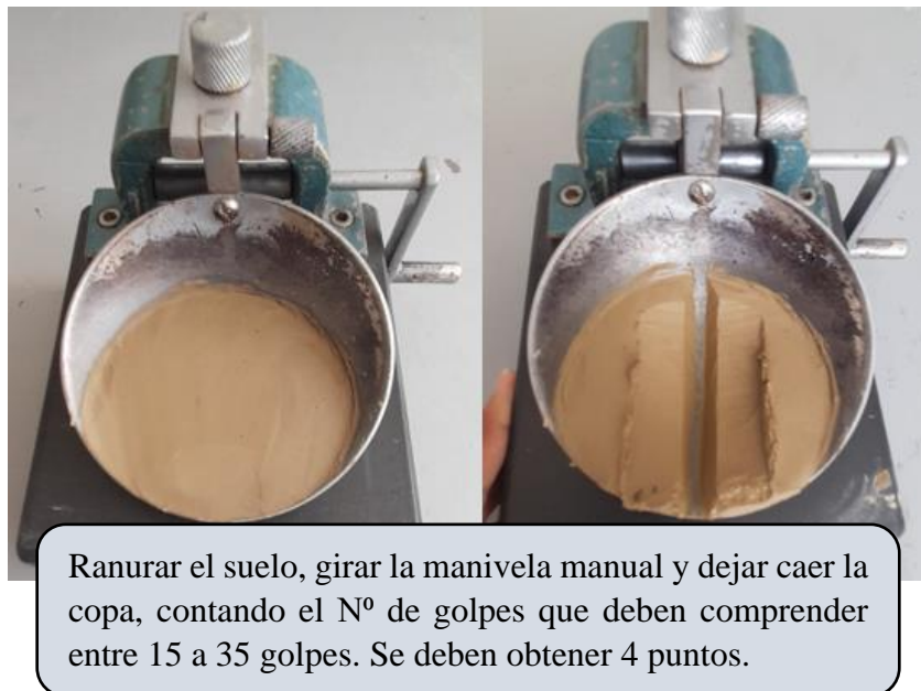
Figura 3. 13 Colocado y ranurado del suelo
