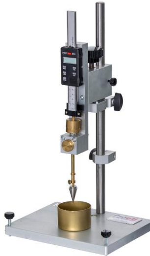
Figura 2. 22 Penetrómetro de caída digital
