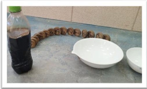
Imagen 14 Imagen 12 Ensayo de límite de contracción utilizando aceite
