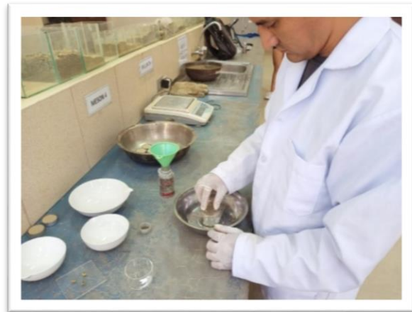
Imagen 10 Ensayo de límite de contracción utilizando mercurio
