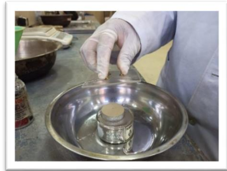
Imagen 13 enracé de la pastilla en mercurio
