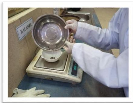
Imagen 15 peso del mercurio desplazado
