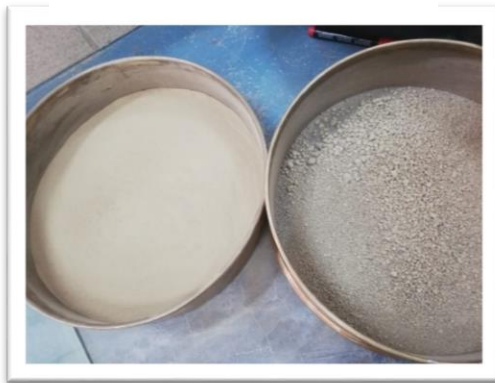
Imagen 3 material que pasa tamiz N°40 para ensayos de límites
