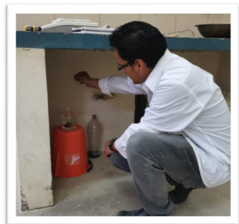
Imagen 16 peso de la pastilla con parafina sumergida
