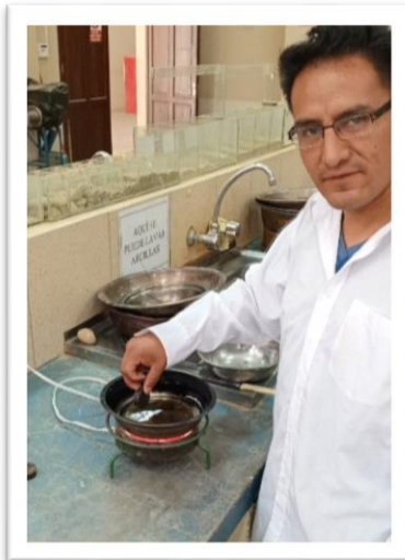
Imagen 11 Ensayo de límite de contracción utilizando parafina
