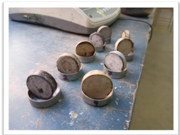
Imagen 18 galletas para determinar el volumen
