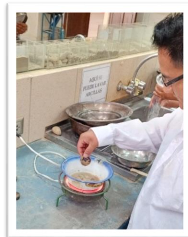
Imagen 12 Ensayo de límite de contracción utilizando glicerina
