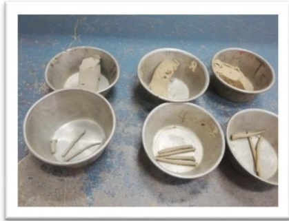
Imagen 7 muestras de limite líquido y plástico
