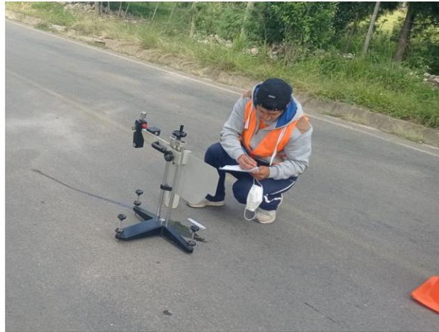
PESAJE DE 25 CM<sup>3</sup> DE ARENA PARA REALIZAR ENSAYO DE CÍRCULO DE
