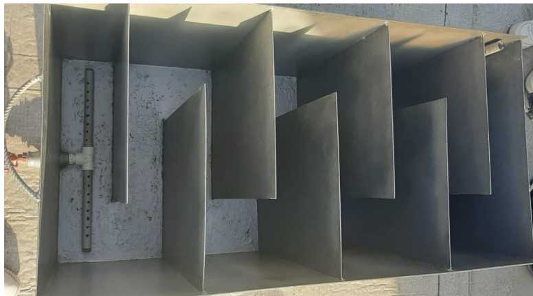
Figura 2-5. Armazón del Biofiltro
