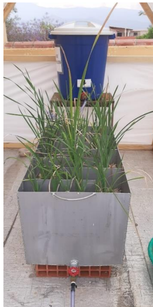
Figura 2-2. Sistema de Biofiltración
