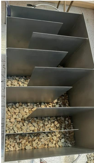
Colocado de la capa de grava inferior
