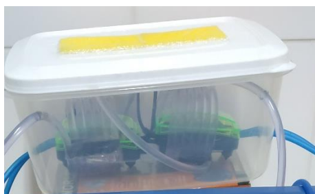
Figura 3-5 Aireadores dentro del filtro de aire.
