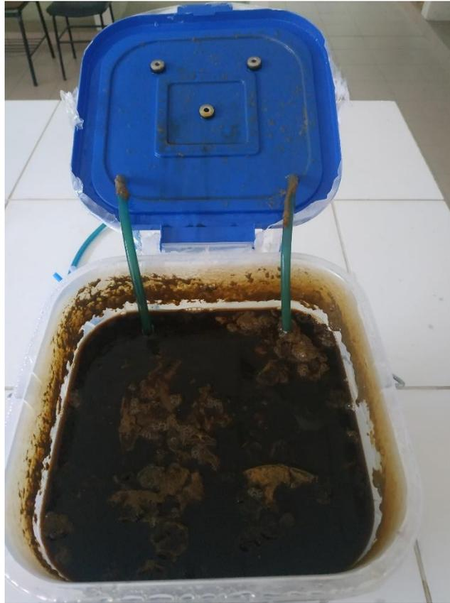
**Biorreactor después de extraer la disolución con ácido cítrico**
