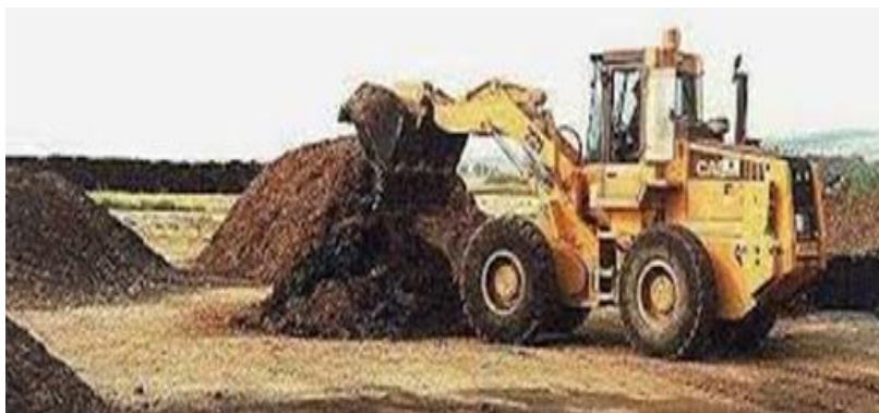
Figura 2-9 Pala Cargadora Volteando la Pila de Compost
