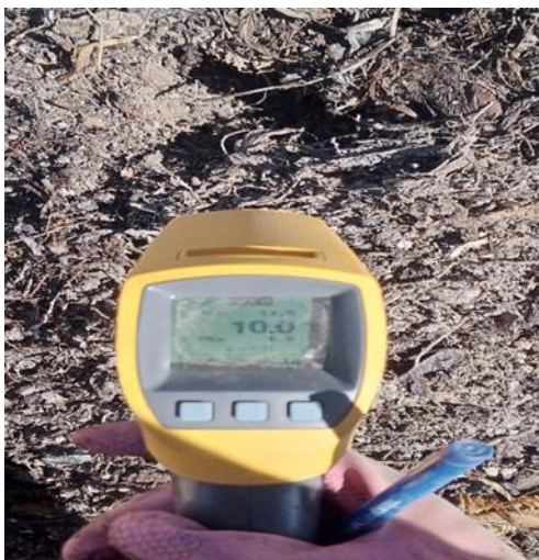
Ilustración 3-10 Termómetro Infrarrojo utilizado para el Control de Temperatura
