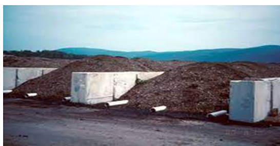
Figura 2-7 Pilas Estáticas con Aireación Pasiva
