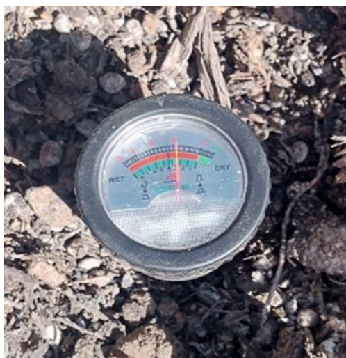
Ilustración 3-11 Valiometro utilizado para el Control de humedad y pH
