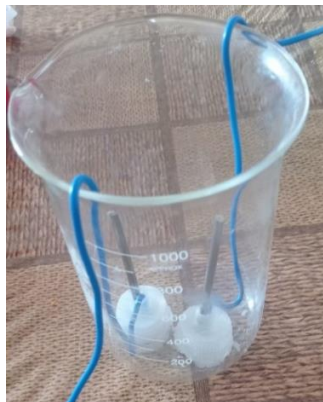
Figura II- 6: Electrodos fijados al beaker
