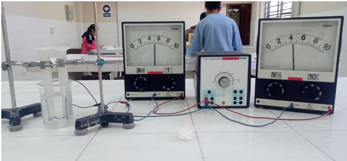
Figura II- 3: Montaje de equipo de electrolisis
