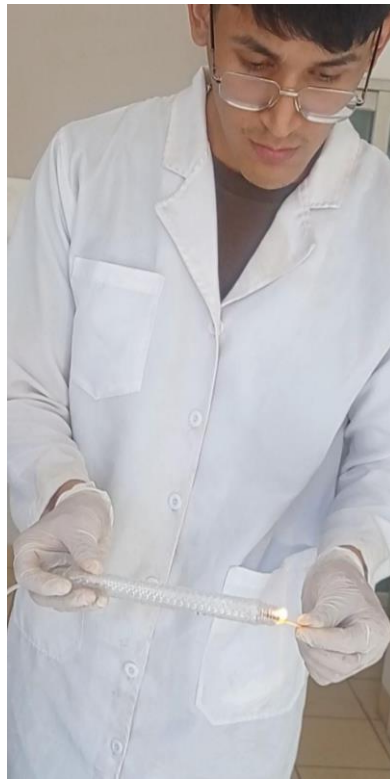
Figura III- 3: Prueba de combustión del gas obtenido
