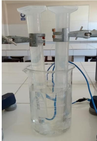
Figura II- 7: Probetas posicionadas en los electrodos
