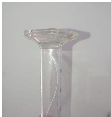
Figura II- 8: Manguera en el interior de la probeta
