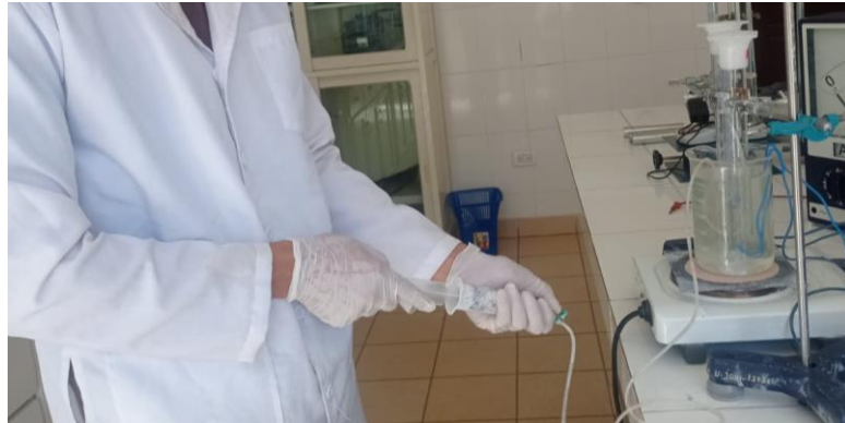
Figura II- 9: Vaciado de aire
