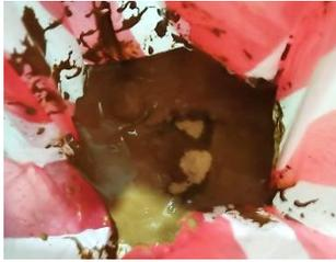
Primeramente, la muestra se deja hidratando por 72 horas en una bolsa plástica para que las partículas de interlaminares de arcilla se hidraten.
