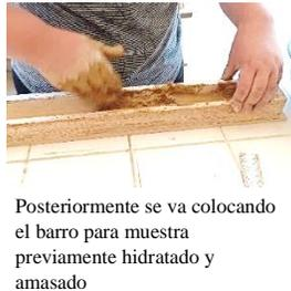
Posteriormente se va colocando el barro para muestra previamente hidratado y amasado
