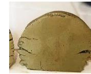
Media esfera lateral derecha. – agrietamiento por corte poco profundas, con un porcentaje bajo de rugosidad y brillo tenue
