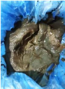
Primeramente, la muestra se deja hidratando por 72 horas en una bolsa plástica para que las partículas de interlaminares de arcilla se hidraten.
