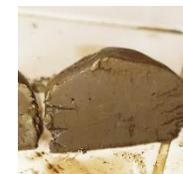
Media esfera lateral derecha. – agrietamiento por corte poco profundas, con un porcentaje bajo de rugosidad y brillo tenue
