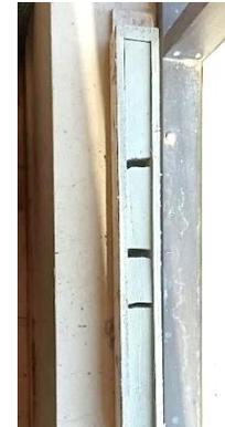
Se puede observar que al retraerse la muestra se fractura en la parte media
