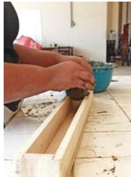
Posteriormente se va colocando el barro para muestra previamente hidratado y amasado
