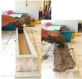
Posteriormente se va colocando el barro para muestra previamente hidratado y amasado
