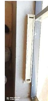
Se puede observar que al retraerse la muestra no se fractura en ninguna parte.
