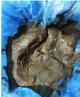
Primeramente, la muestra se deja hidratando por 72 horas en una bolsa plástica para que las partículas de interlaminares de arcilla se hidraten.
