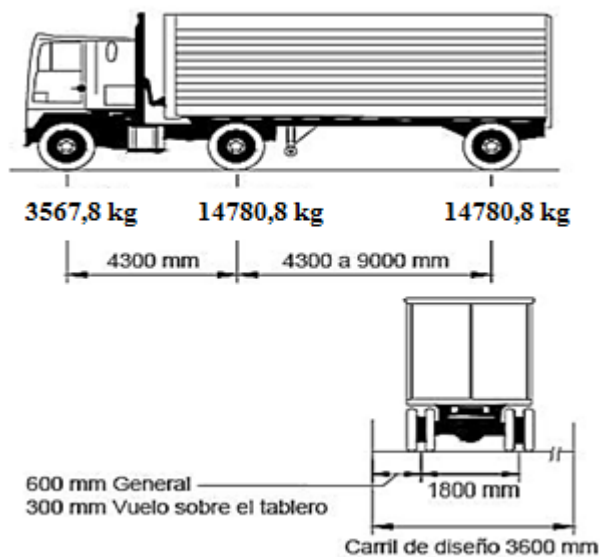
FIGURA N° 2.5 Características del camión de Diseño
