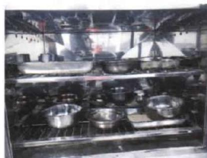
**Lavado de muestras por tamiz N°200, posterior secado de muestras en horno a temperatura  $110 \pm 5$  °C.**
