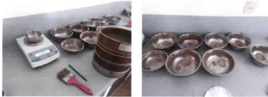
**Granulometría por tamizado y pesaje de suelo retenido en balanza de precisión 0,01 gr.**
