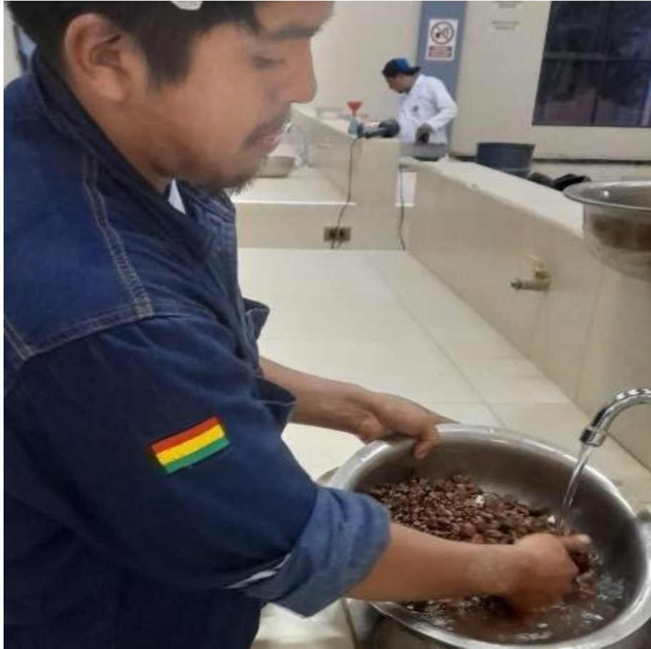
Figura 8: Lavado agregado grueso – grava 3/4" (desgaste de los ángeles)
