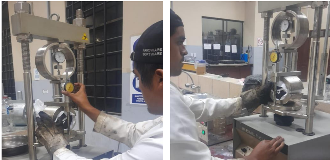
Figura 39: Rotura de briquetas en el equipo Marshall
