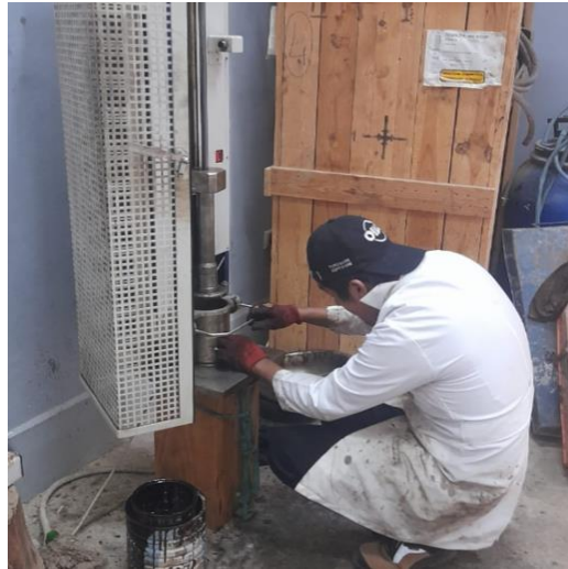
Figura 31: Compactado de la mezcla asfáltica
