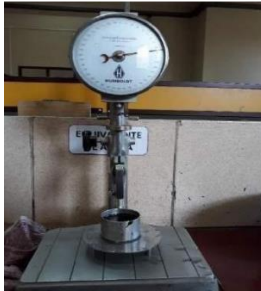
Figura 22: Ensayo de penetración
