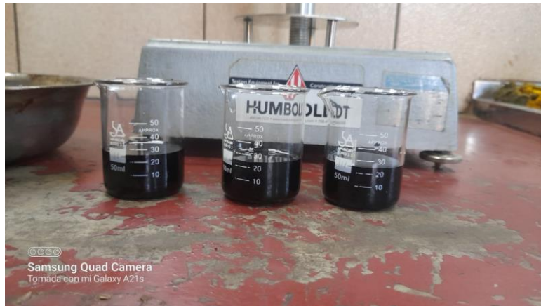
Figura 24: Realización ensayo peso específico cemento asfáltico
