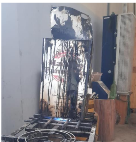
Figura 28: Calentamiento del cemento asfáltico
