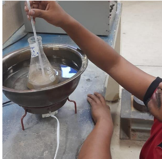
Figura 20: Realización ensayo peso específico filler convencional
