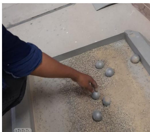
Figura 9: Extracción agregado grueso-gravilla 3/8" de maquina desgaste de los ángeles
