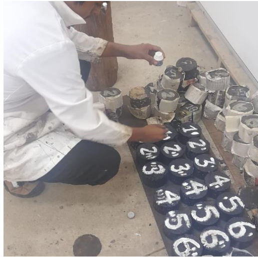
Figura 33: Briquetas con distintos porcentajes de cemento asfáltico
