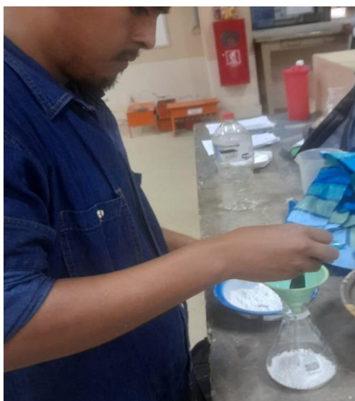
Figura 21: Realización ensayo peso específico filler carbonato de calcio
