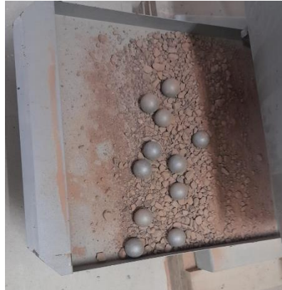
Figura 7: Máquina de desgaste de los ángeles y material ensayado
