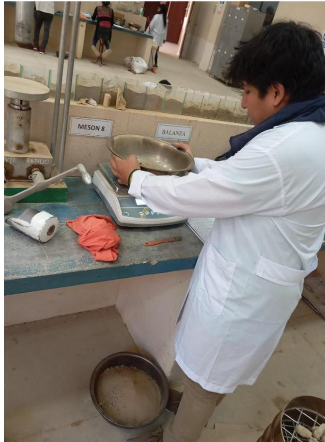
Ensayo de mezclas granulométricas de los diferentes métodos
