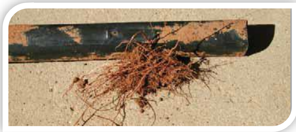
Figura 15: Intrusión de raíces en el emisor
