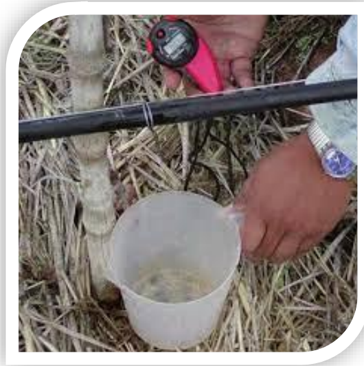
Figura 13: Estimación del caudal de un gotero
