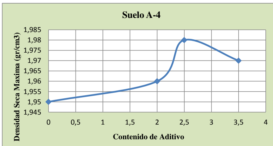
Figura IV-15 Influencia del contenido de CON-AID en la densidad máxima del suelo (A-4)
