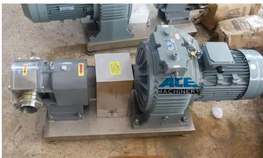
Cuadro N° III - 2. Bomba de transferencia para líquidos viscosos
