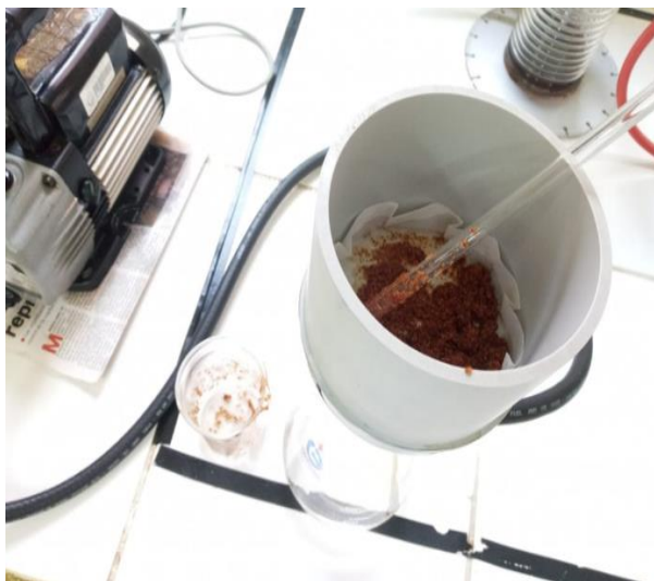
Figura 2-14. Filtración al vacío del exceso de agente activante
