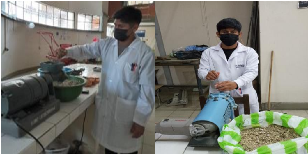
Figura 2-9. Molienda de la cáscara de maní con el molino de discos y molino de martillos
