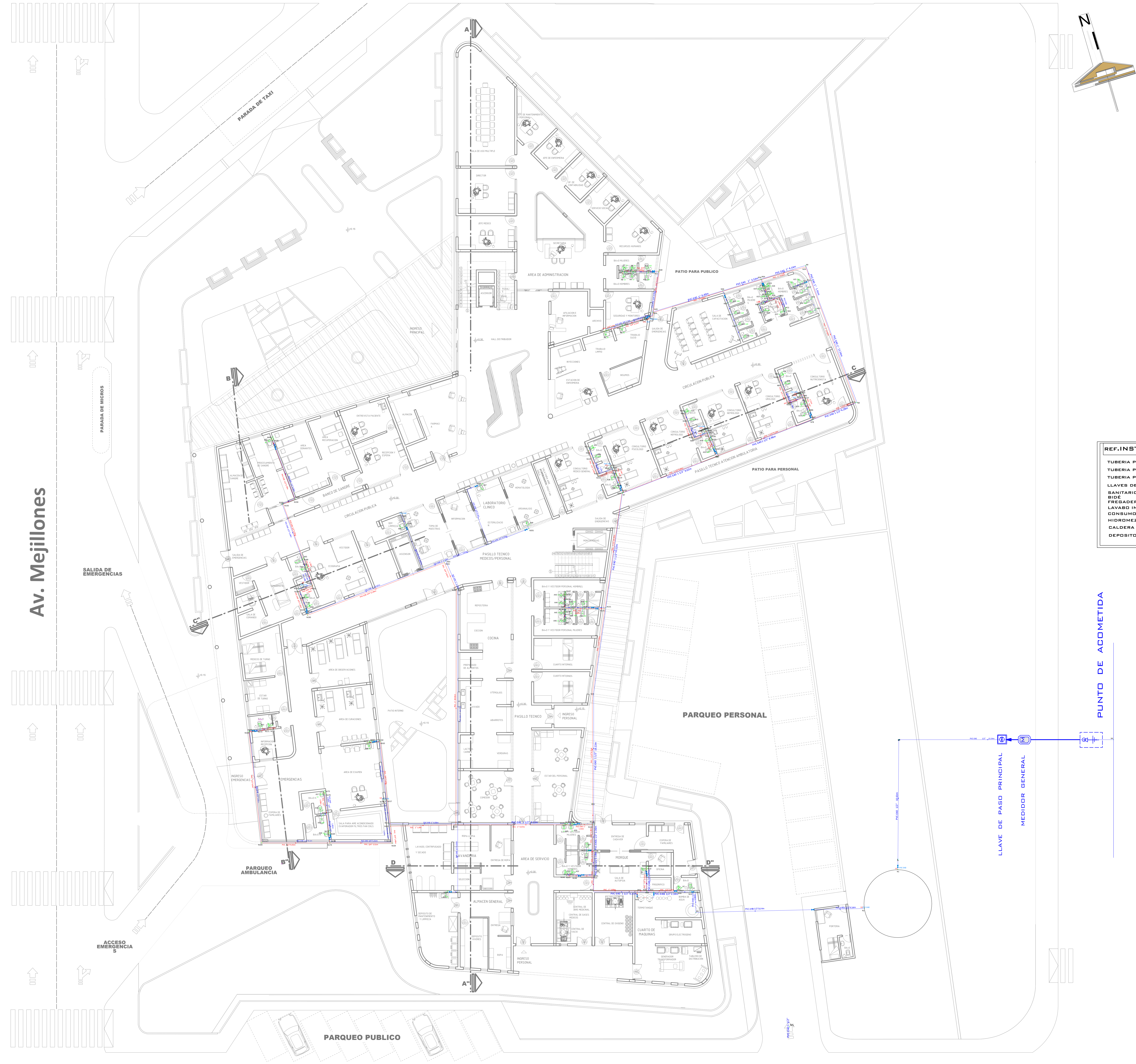
PLANO DE PLANTA BAJA - INSTALACION DE AGUA POTABLE
