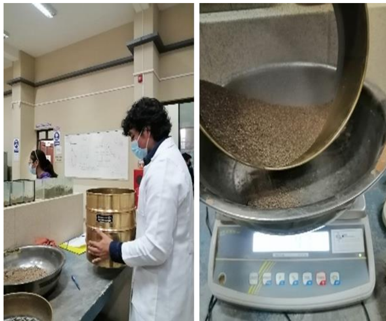
Figura 2.9. Ensayo de granulometría
