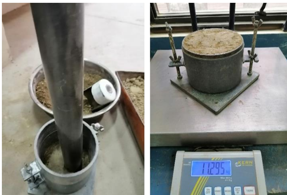
Figura 2.11. Ensayo de compactación
