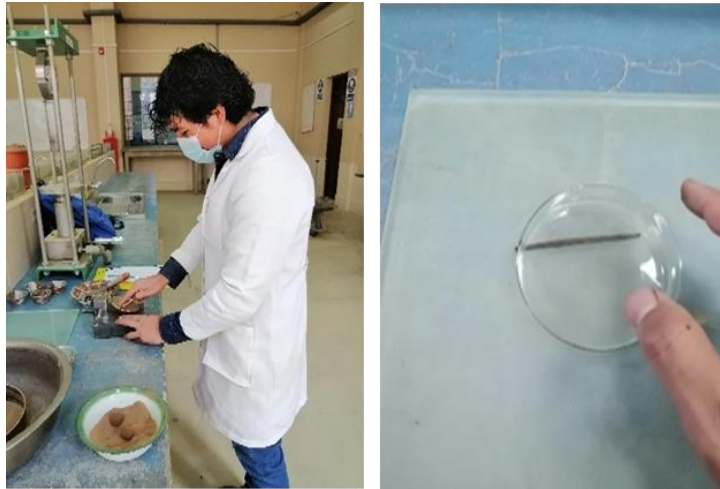
Figura 2.10. Ensayo de límite líquido y límite plástico
