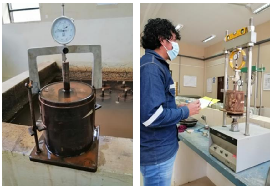
Figura 2.12. Ensayo del CBR
