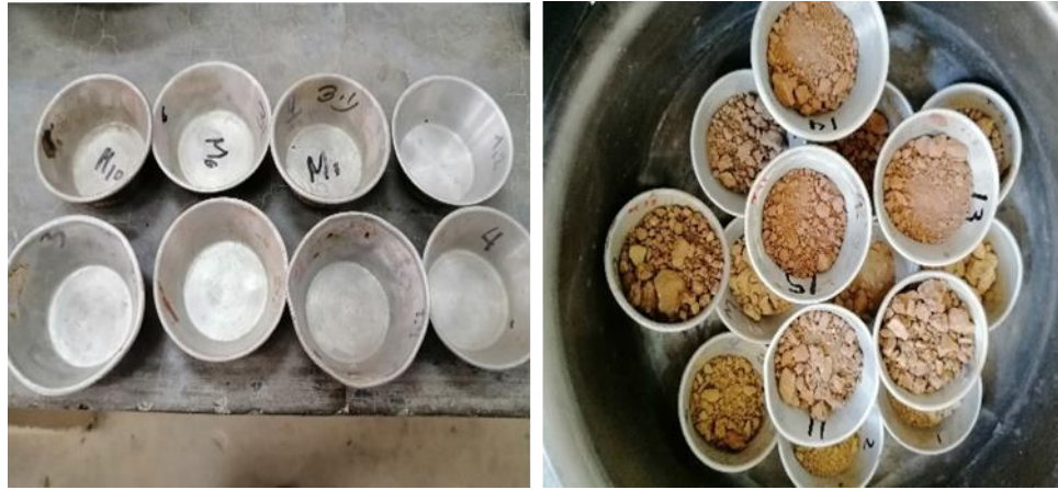
Figura 2.8. Ensayo contenido de humedad
