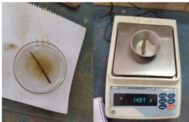
Fotografía 10: Ensayo limite plástico
