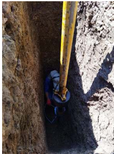
Fotografía 6: Ensayo SPT para estudio de suelo
