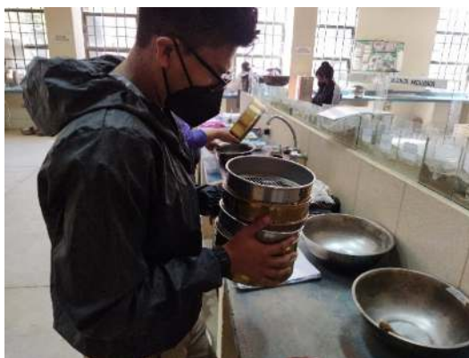
Fotografía 7: Ensayo de granulometría para clasificación de suelo
