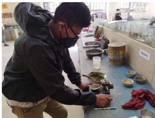
Fotografía 8: Ensayo de límites de Atterberg para clasificación del suelo
