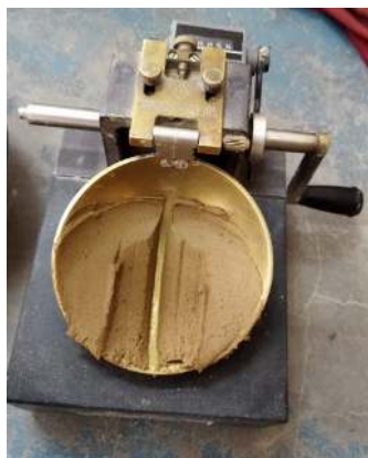
Fotografía 9: Equipo casa grande para ensayo limite liquido
