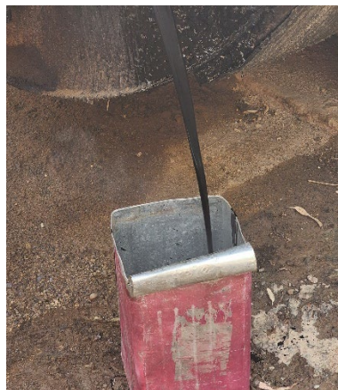
Figura 3.2. Recolección del cemento asfáltico
