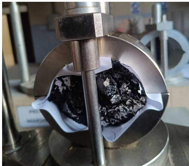
Figura 4.3. Ruptura de briquetas con fibras de acero preliminar
