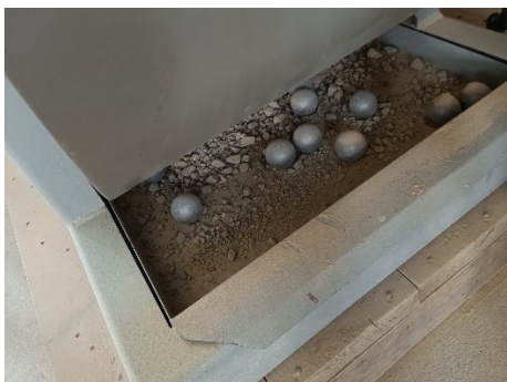
Figura 3.7. Realización del ensayo de desgaste de los Ángeles
