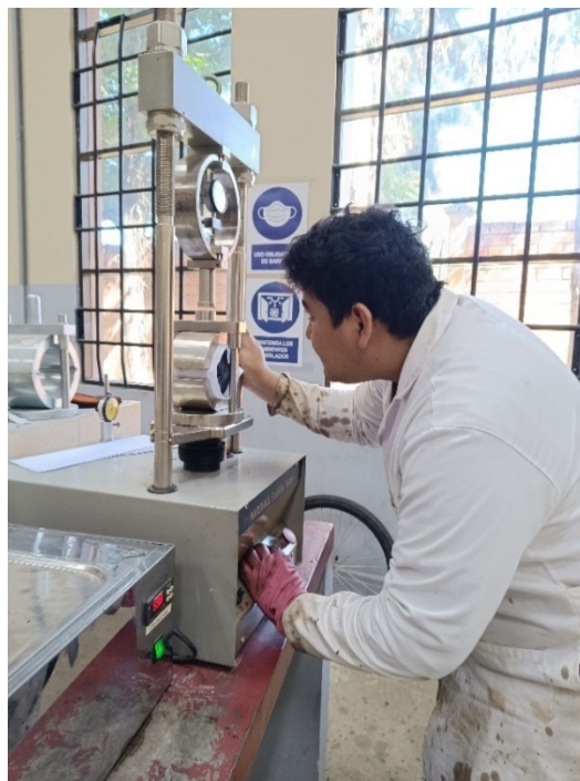
Figura 4.1. Ruptura de briketa en ensayo Marshall
