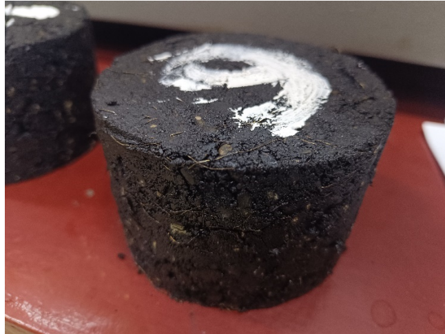
Figura 4.2. Elaboración de briquetas con fibras de acero preliminares
