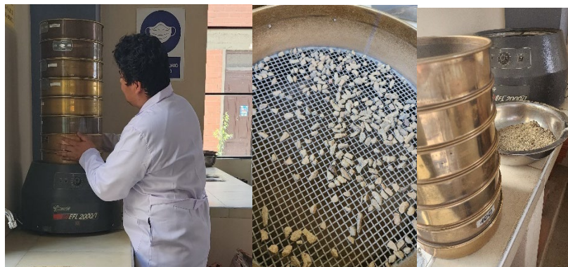
Figura 3.4. Granulometría de los agregados (Grava (3/4”), gravilla (3/8”) y arena)
