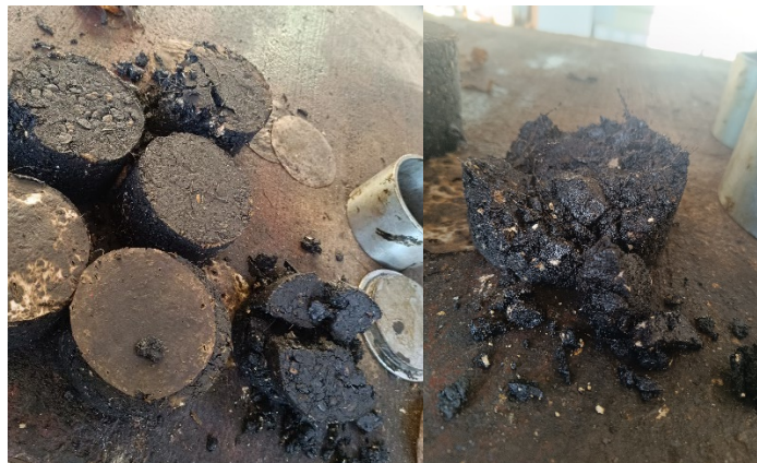
Figura 4.5. Briquetas desmoronadas con fibras de acero recicladas largas
