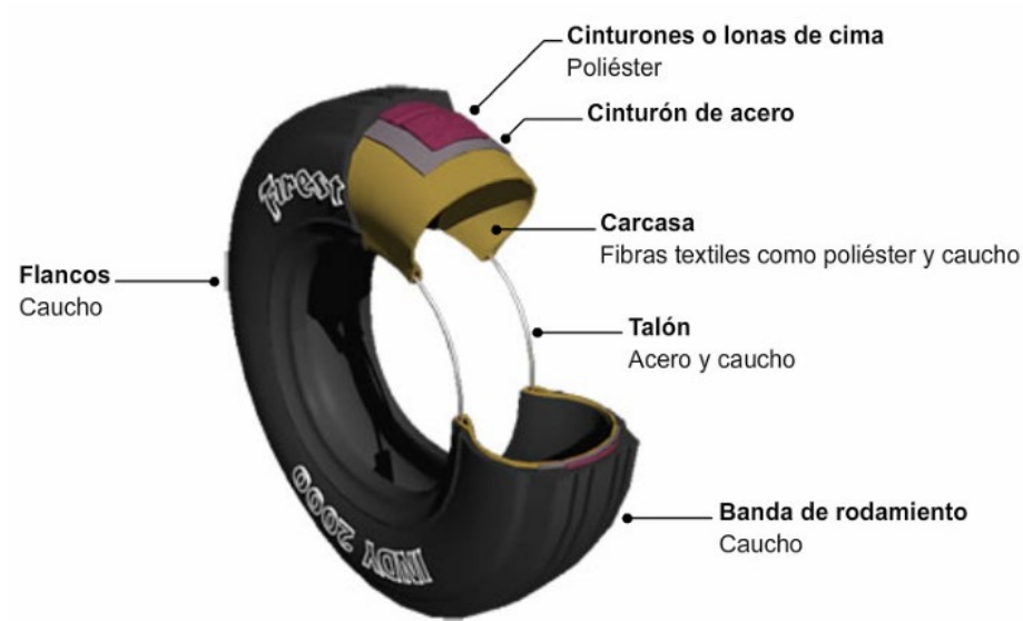
Figura 2.5 Partes de un neumático
