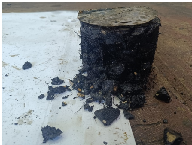
Figura 4.4. Desmoronamiento de briqueta con 5% de fibras de acero
